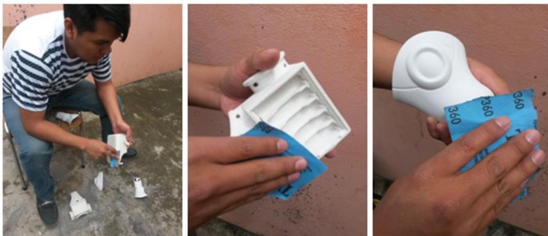
(a) Pulido del Pecho (b) Pulido de la espalda (c) Pulido pieza de la pierna
