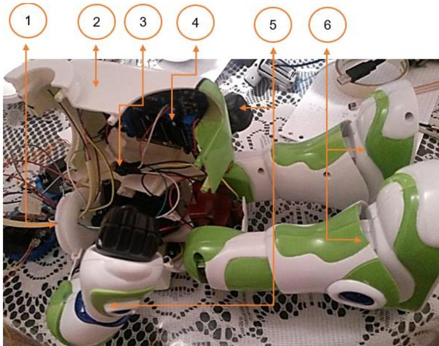
**Figura 151 Ensamble Torso parte electrónica**
