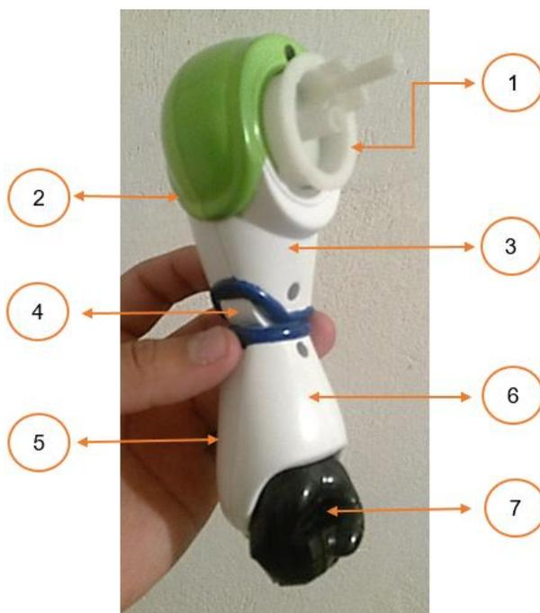
**Figura 146 Ensamble del brazo**
