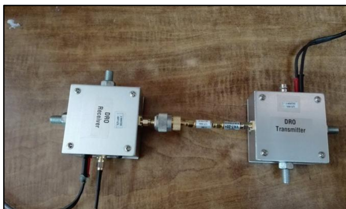
Figura 66: Conexión de equipos para medición de F.I.
