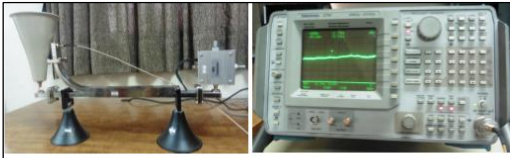
Figura 76: Potencia incidente/reflejada empleando analizador de espectros.
