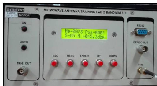
Figura 69: Medición de la potencia recibida en el SCU.
