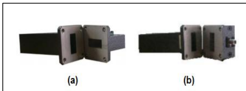
Figura 62: Ejemplo (a) Guía de onda desacoplada y (b) Guía de onda acoplada
