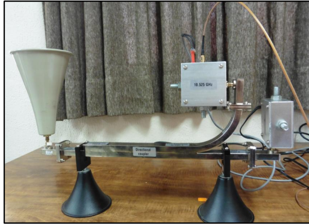
Figura 75: Medición de VSWR (potencia reflejada).
