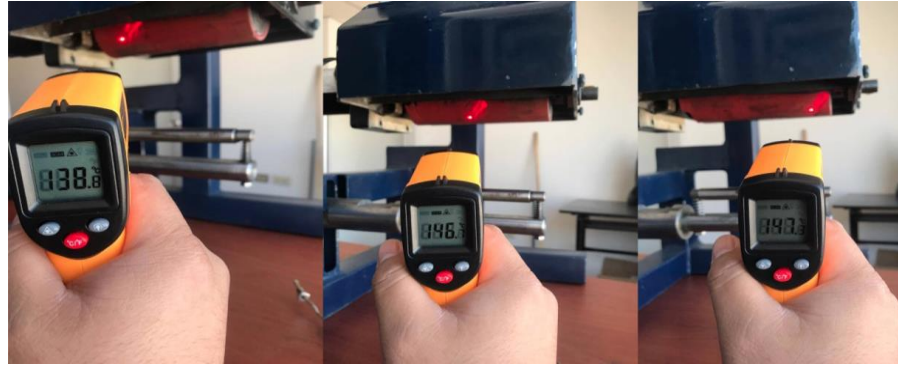
Figura 82. Temperatura en las 3 secciones del cilindro
