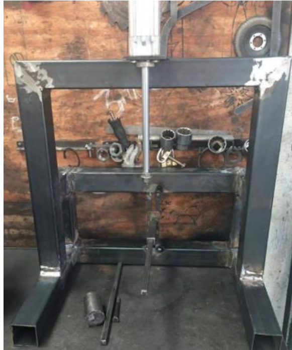
Figura 61. Actuador adaptado a la estructura base
