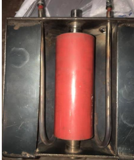
Figura 65. Campana acoplada con cilindro fusor y resistencia
