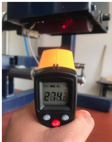
Figura 84. Prueba temperatura con pistola laser
