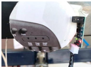
Figura 87. Encoder adaptado al eje del cilindro
