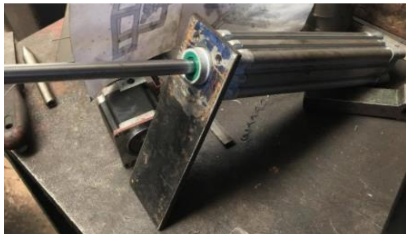
Figura 60. Actuador neumático con la platina
