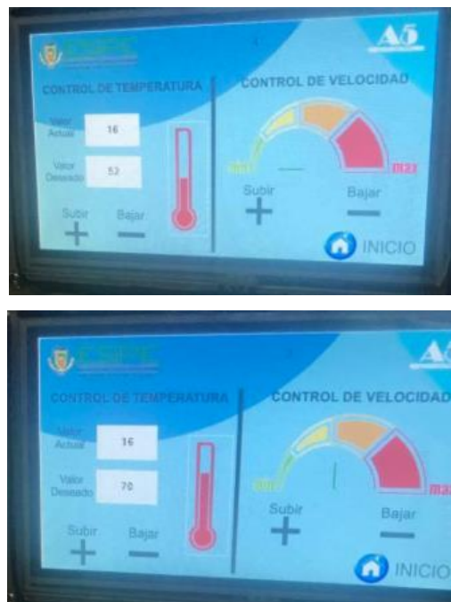
Figura 79. Prueba táctil de la pantalla nextion
