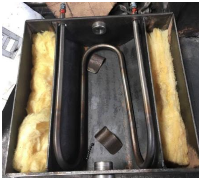
Figura 64. Campana con resistencia eléctrica
