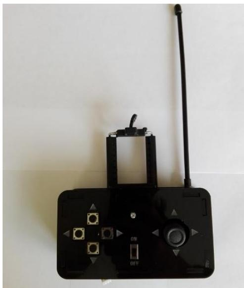
**Figura 88** Resultado final de la construcción del control remoto
