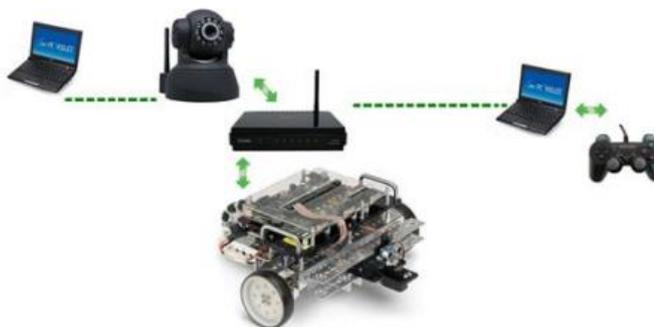
**Figura 16** Esquema de conexión de sistema robótico
