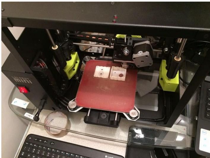
**Figura 59** Manufactura del Brazaete Inteligente por impresión 3D
