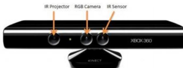
**Figura 7** Dispositivo Kinect y sus componentes
