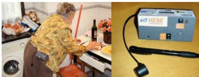
**Figura 6** Dispositivo portátil para detección automática de caídas
