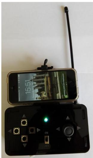
**Figura 89** Control remoto con la integración de un dispositivo móvil
