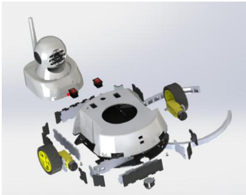
**Figura 34** Vista explotada del robot diferencial de videovigilancia
