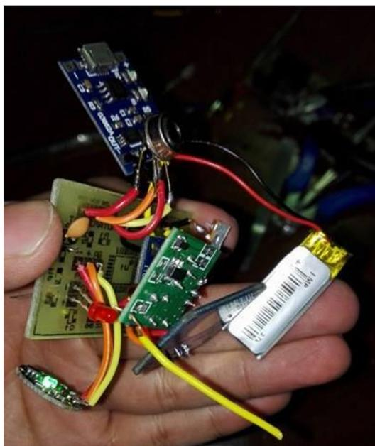
**Figura 58** Componentes del Brazaete Inteligente integrados en el PCB
