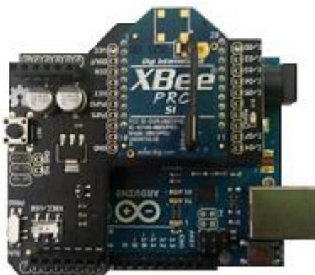
**Figura 3** Arduino con módulo de comunicación "ZigBee"
