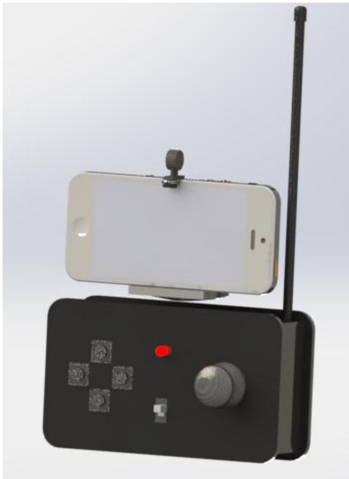
**Figura 51** Concepto final del control remoto del robot
