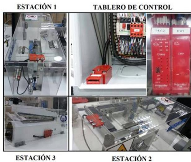
**Figura 80 Elementos de seguridad implementados**
