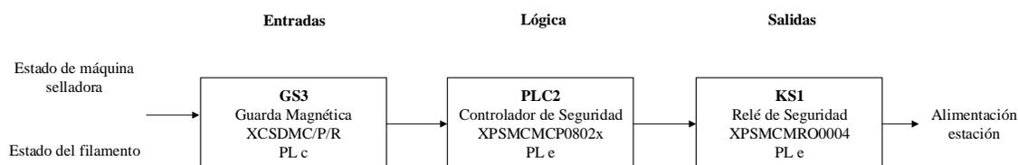
**Figura 28 Funciones de seguridad de empacado**
