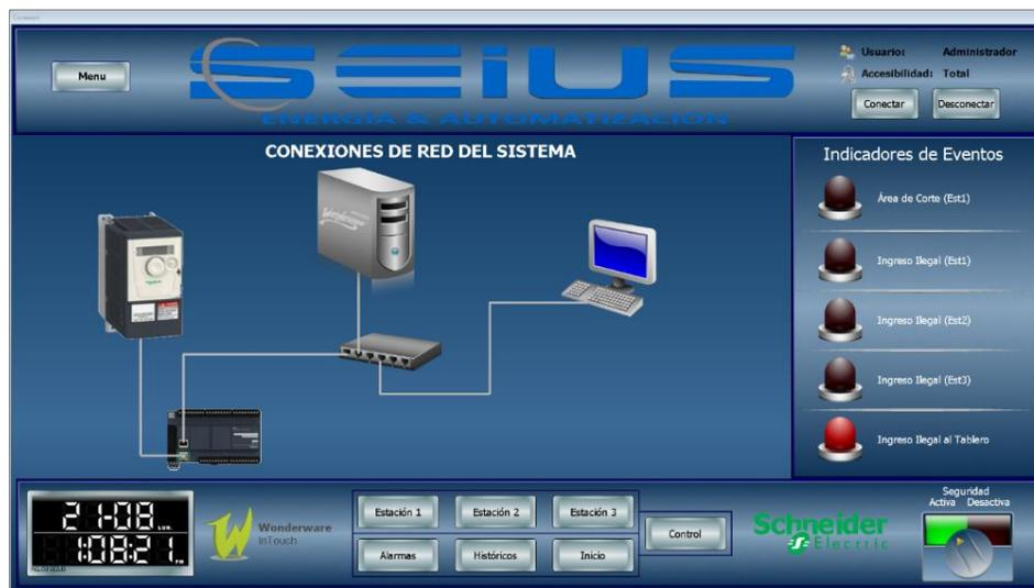
**Figura 74 Ventana de conexiones**
