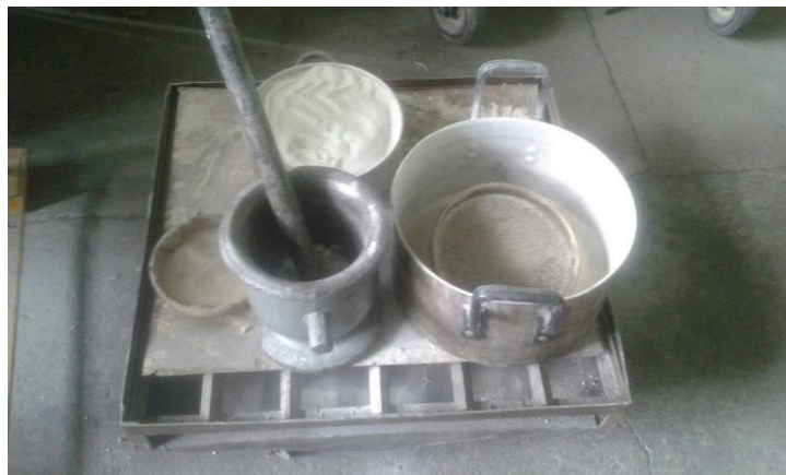
Figura 44: Preparación de la Mezcla
