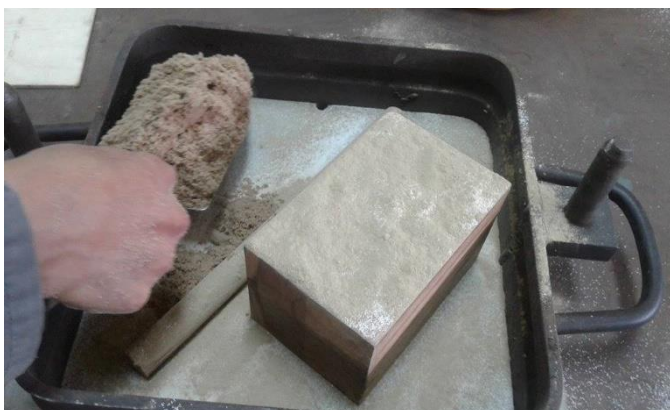
Figura 42: Moldeo del modelo
