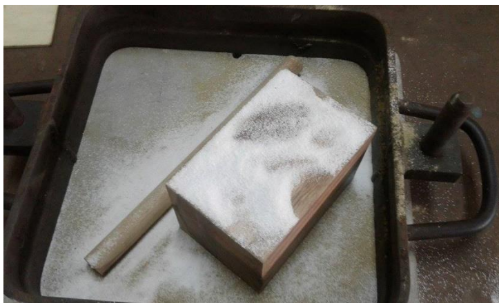
Figura 41: Aplicación de bentonita en el modelo
