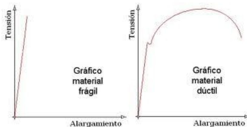
Figura 18: Diagrama esfuerzo-deformación para material dúctil y frágil
