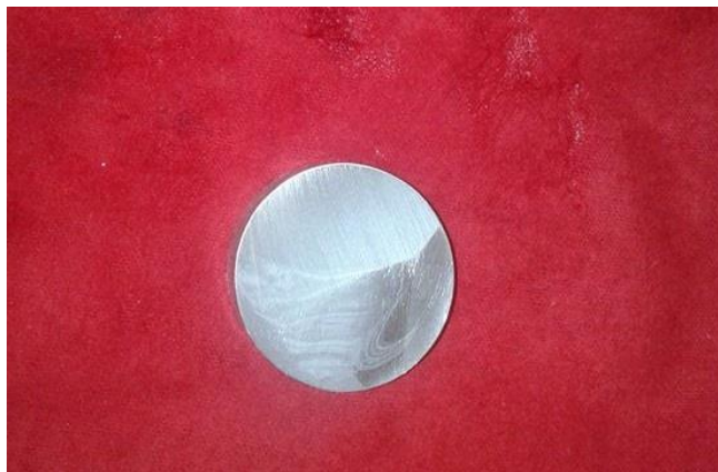
Figura 48: Muestra luego de lijar y obtener el espejo
