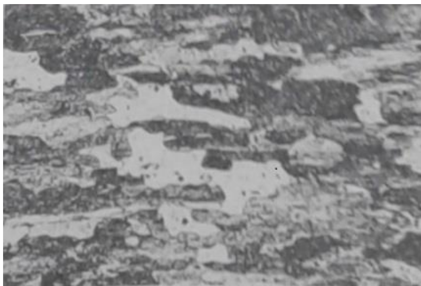
Figura 14: Metalografía del Al 95% y Cu 5%
