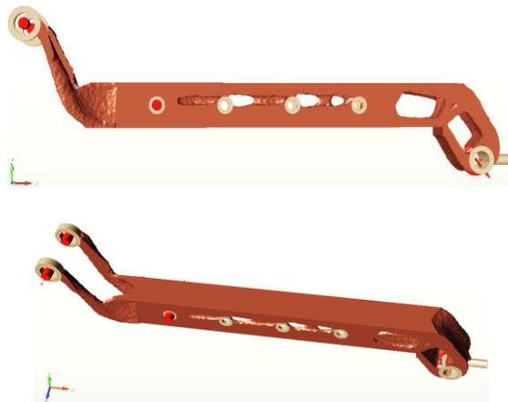
**Figura 125 Diseño mediante optimización topológica**
