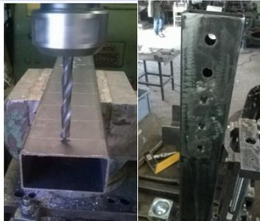
Para la construcción de la columna principal, primero se la corta de acuerdo con las dimensiones establecidas, y luego mediante una máquina fresadora se procede a hacer las diferentes perforaciones que se necesita en la misma.
