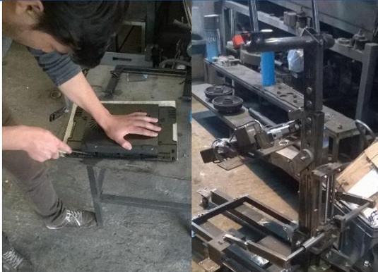
De igual manera que para la columna principal, se corta los perfiles y se los fresa de acuerdo con las dimensiones establecidas en los planos, seguido de la realización del soporte para la mesa que conlleva doblar un tubo y soldar el soporte para las manecillas.
