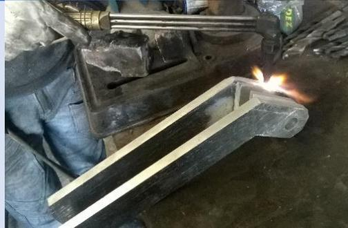
El brazo principal, el cual está conformado por aleación de aluminio 6061T6 debido a sus funciones, en la construcción del brazo, primero se precisa trazar sus dimensiones en la plancha del material, continuando con la construcción del brazo, se prosigue al corte de la plancha de aluminio hasta conseguir la forma requerida.
