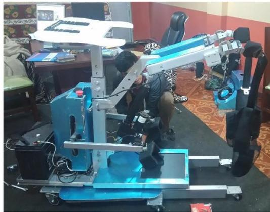
**Figura 153 Bipedestador ensamblaje final**
