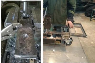
Para la parte del sistema de pesaje, en donde están inmiscuidas las bolas de transferencia, se requiere hacer varias perforaciones para la fijación de las mismas por lo cual se recurre a utilizar la fresadora para realizar las operaciones. Además, se realiza el marco para la batería usando perfiles en L que luego serán soldadas, para por último ser fijados con pernos a las barras.
