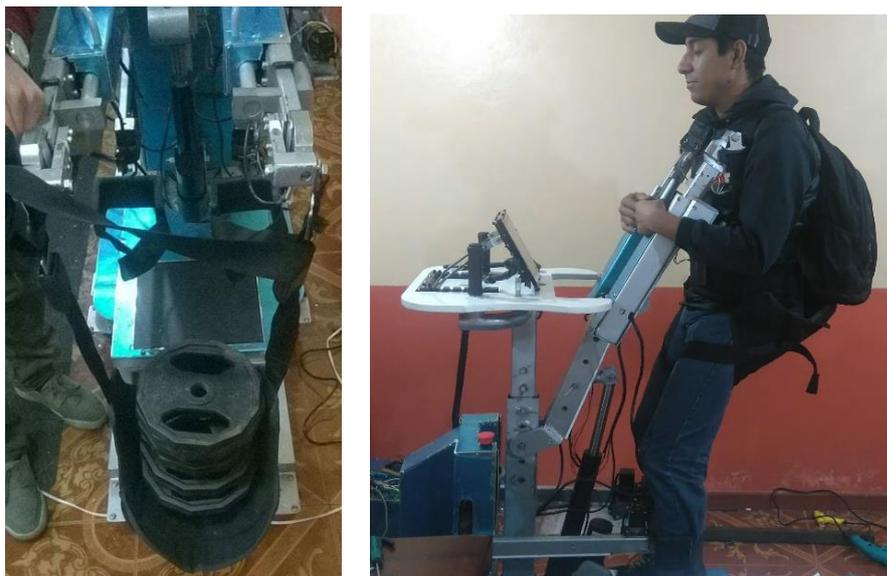
**Figura 162 Sistema de elevación y brazos telescópicos sometido a carga**
