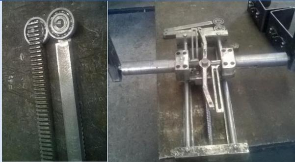
Se llega a la construcción de los acoples y soportes para la sujeción del usuario, así también se tiene a la cremallera la cual se ha optado por comprarla para luego solo maquinar las partes necesarias y adaptarlas al sistema.
