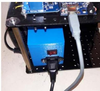
**Figura 50 Conexión del dispositivo al computador y a la toma de 110 V**
