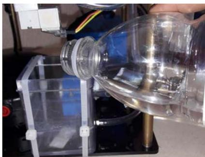
**Figura 51 Colocación de dopante en el contenedor principal**
