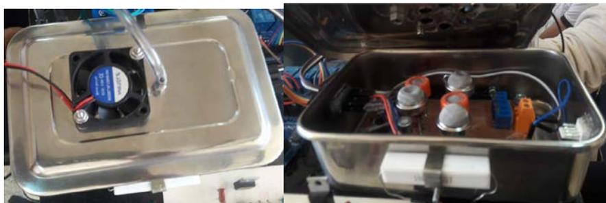
**Figura 42 Cámara de sensores**
