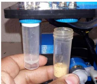
**Figura 54 Colocación de depósito de muestra y dopante**
