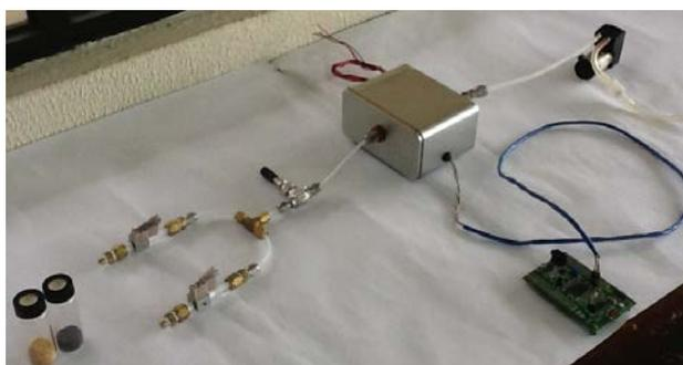
**Figura 40 Prototipo inicial de nariz electrónica E-NOSE**
