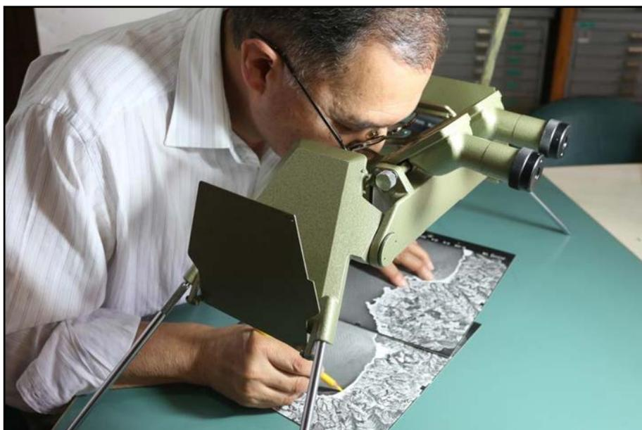
**Figura 3 Observación de fotografías aéreas con el estereoscopio de espejos**
