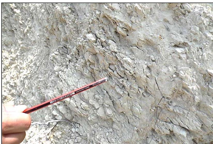
**Figura 47 Formación Ónzole Superior: arcillitas tipo esmectita. Afloramiento en el barrio “Tercer Piso” - Esmeraldas**
