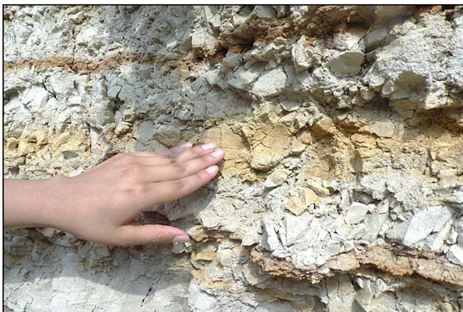
**Figura 69** Arcillita expansiva, con inclinación hacia la pendiente
