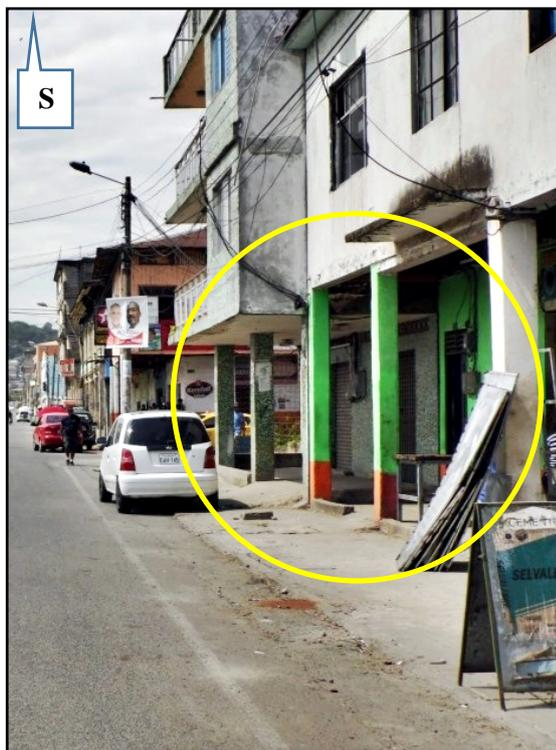
**Figura 87 Construcciones con "piso blando"
