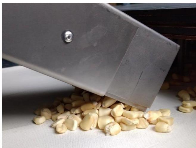
*Figura 59. Salida del grano hacia la banda transportadora*
