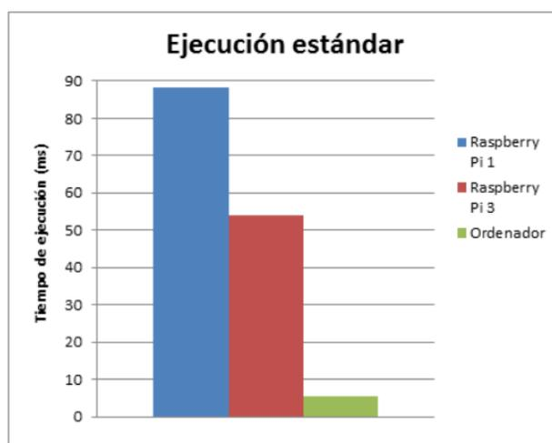
Figura 67. Comparación de los tiempos de ejecución del programa en el ordenador y Raspberry Pi
