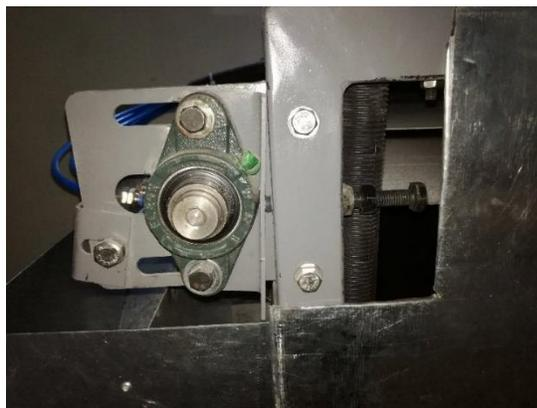
*Figura 97. Implementación del sistema tensor*
