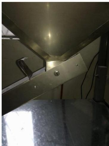
*Figura 93. Ducto de salida*
