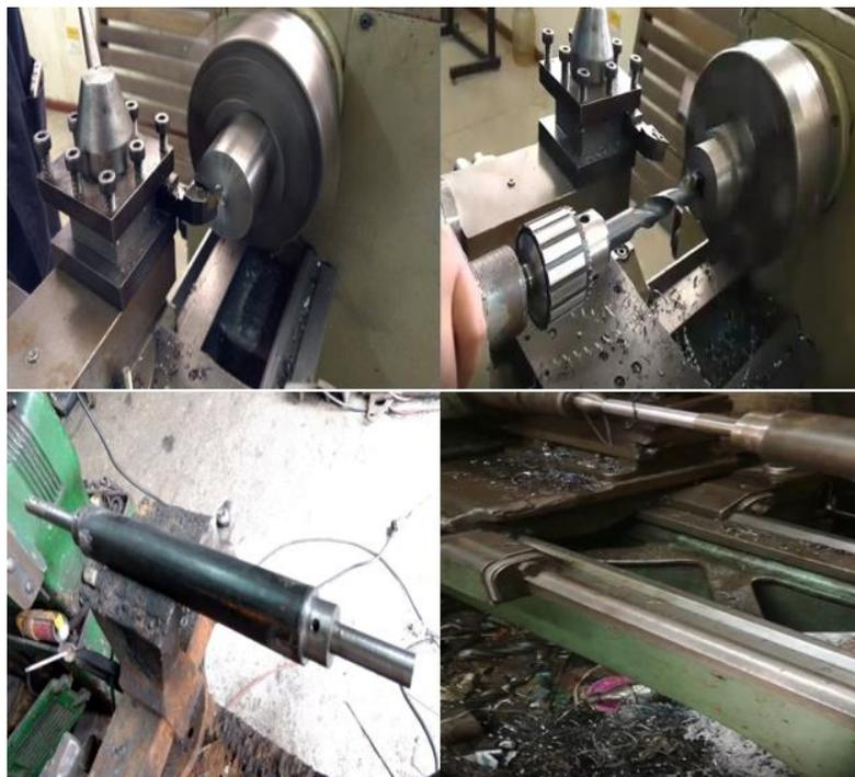
*Figura 90. Maquinado de los rodillos*
