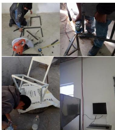
*Figura 102. Elaboración del soporte para el computador*
