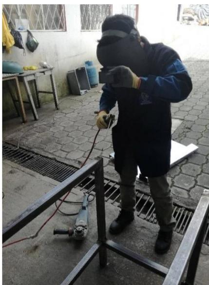
*Figura 86. Soldadura de la estructura*
