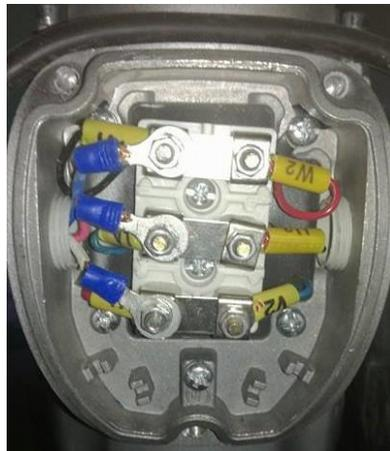
*Figura 103. Conexión de las puntas del motor*
