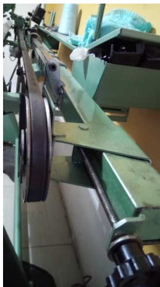
Figura 114 Estructura de soporte del sistema motriz montada en la máquina
