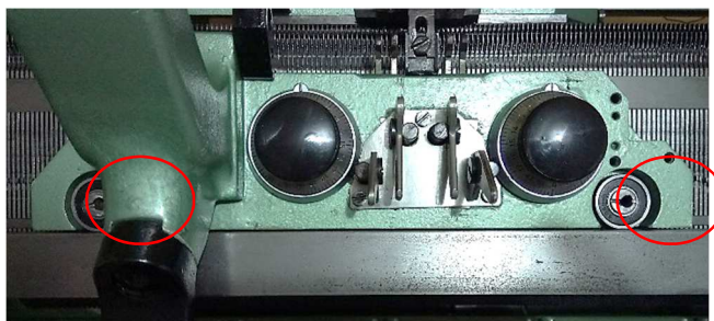
Figura 71 Rodamientos radiales de bola 6000 2RS con eje excéntrico para calibración del carro
