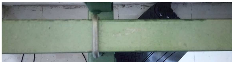
Figura 115 Perno en U para la sujeción de la estructura de soporte del sistema motriz
