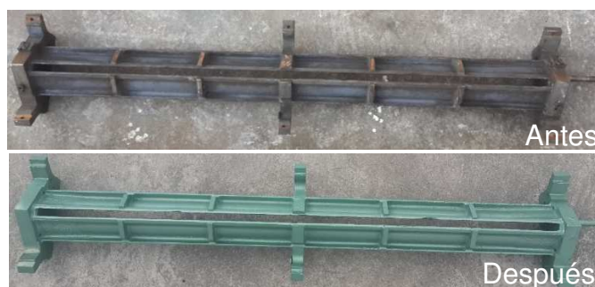
Figura 35 Antes y después del estado de la estructura de soporte de la Frontura El proceso realizado para cada parte de la frontura se desglosa a detalla a continuación:
