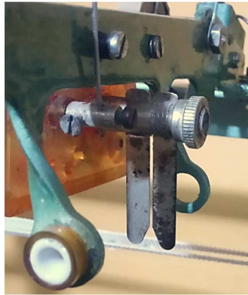
Figura 111 Mecanismo de sensado de nudo en el hilo
