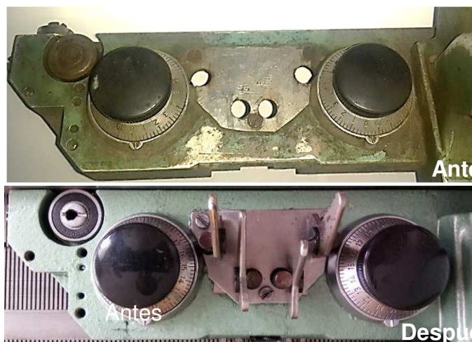
Figura 45 Antes y después del estado del sistema de tensión del tejido
