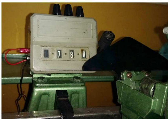
Figura 126 Sistema de conteo del número de pasadas del carro tejedor
