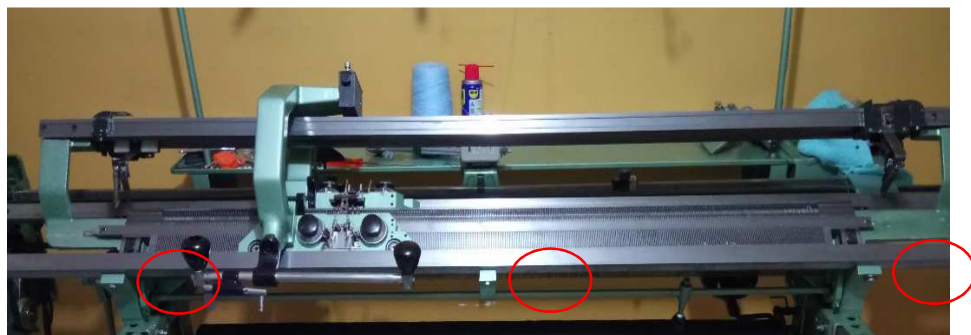
Figura 64 Apoyos y pernos de sujeción del riel frontal para el desplazamiento del carro
