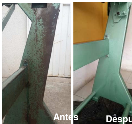
Figura 60 Antes y después de la estructura de soporte de la máquina
