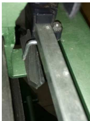
Figura 128 Rotación causada por el carro tejedor en los topes
