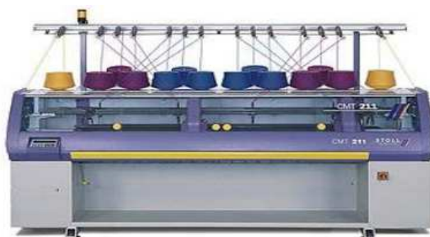
Figura 19 Máquina de tejer electrónica STOLL CMS 411 TC (Gladys Celesteciele, Tejido de punto por trama, 2015)
