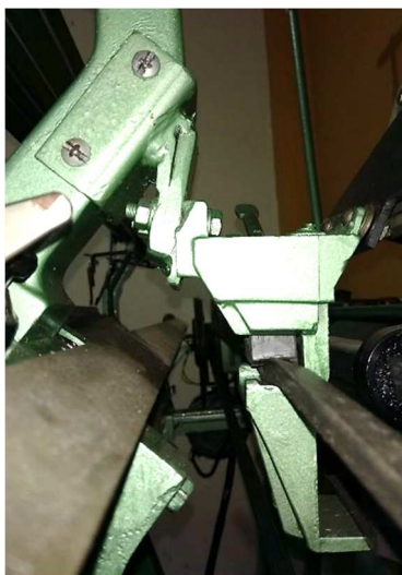
Figura 124 Implementación de la mordaza en el carro tejedor
