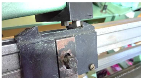
Figura 82 Agarre de los transportadores a la caja de los guía hilos
