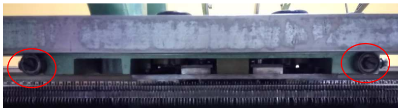
Figura 72 Rodamientos radiales de bola 607 RS con eje excéntrico para calibración del carro
