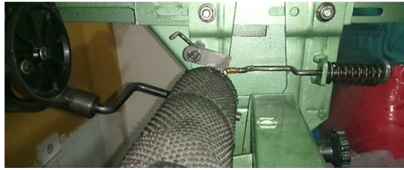
Figura 119 Mecanismo de giro para el cilindro giratorio
