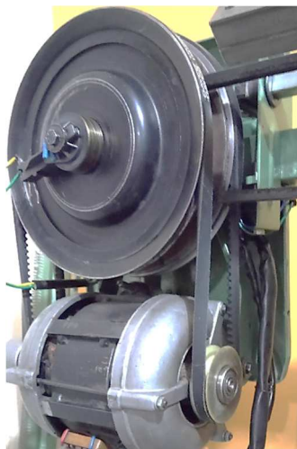
Figura 122 Implementación del sistema motriz en la máquina
