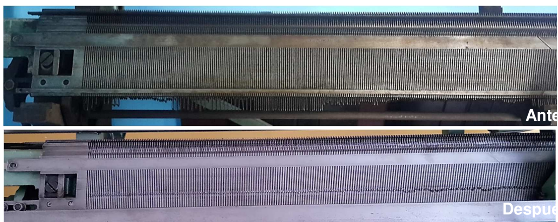
Figura 40 Horquetas de la cama ubicadas en sus respectivas ranuras
