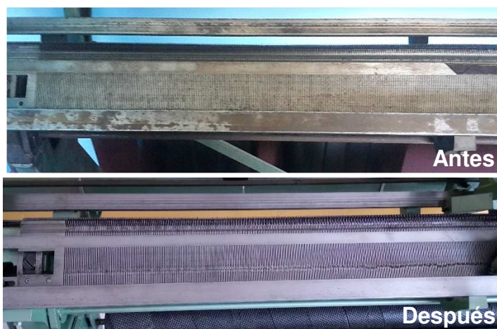
Figura 38 Antes y después del estado del riel de soporte del carro de tejer
