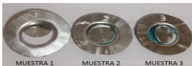
**Figura 37.** Muestras de ensayos, aleación de aluminio 3003 en frío, diámetro de disco de 100 mm
