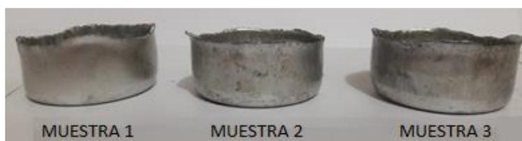
**Figura 35.** Muestras de ensayos, aleación de aluminio 3003 en caliente, diámetro de disco de 80 mm
