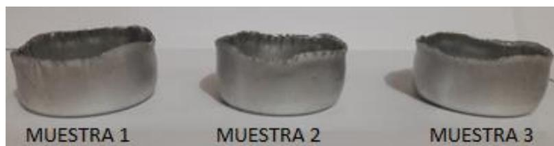
**Figura 33.** Muestras de ensayos, aleación de aluminio 3003 en frío, diámetro de disco de 80 mm
