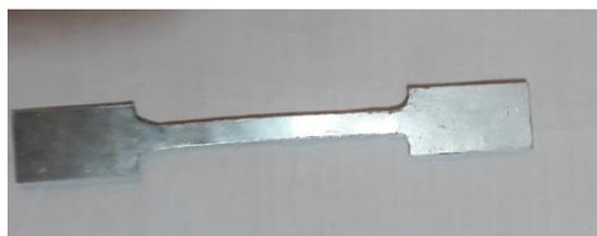
**Figura 3.** Probeta de aleación de aluminio 3003
