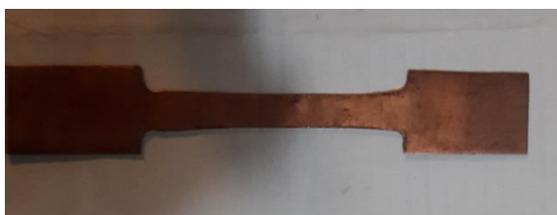
**Figura 4.** Probeta de aleación de cobre C24000
