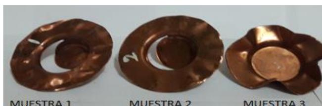
**Figura 43.** Muestras de ensayos, aleación de cobre C24000 en frío, diámetro de disco de 100 mm
