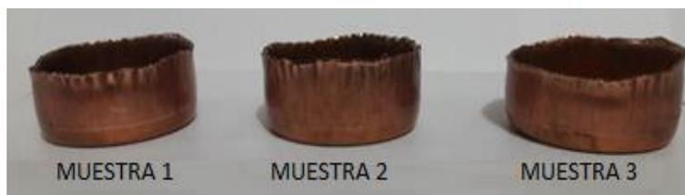
**Figura 39.** Muestras de ensayos, aleación de cobre C24000 en frío, diámetro de disco de 80 mm
