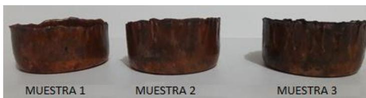
**Figura 41.** Muestras de ensayos, aleación de cobre C24000 en caliente, diámetro de disco de 80 mm
