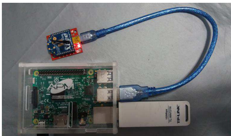
Figura 36: Montaje de hardware nodo coordinador
