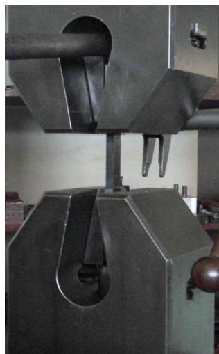
Figura 11 Ensayo de tracción, Material PLA
