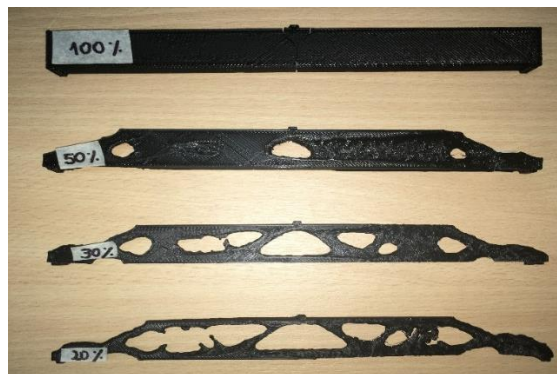
Figura 218 Prototipos impresos de la viga rectangular a flexión con el 100%, 50%, 30% y 20% de masa, Material ABS y PLA
