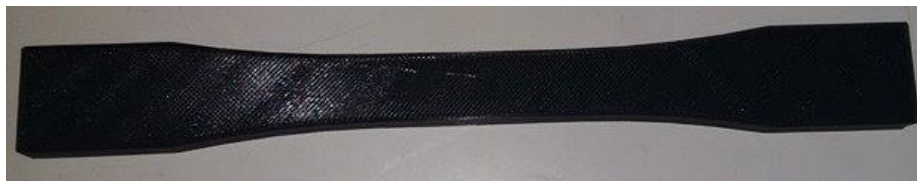
Figura 10 Probeta 1 a tracción impresa, Material PLA
