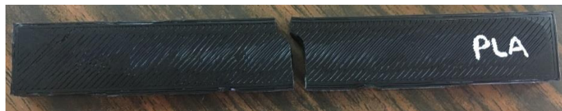
Figura 23 Probeta 3 de Flexión Ensayada, Material PLA
