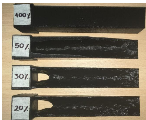
Figura 220 Prototipos impresos del prisma cuadrado a flexo torsión con el 100%, 50%, 30% y 20% de masa, Material ABS y PLA
