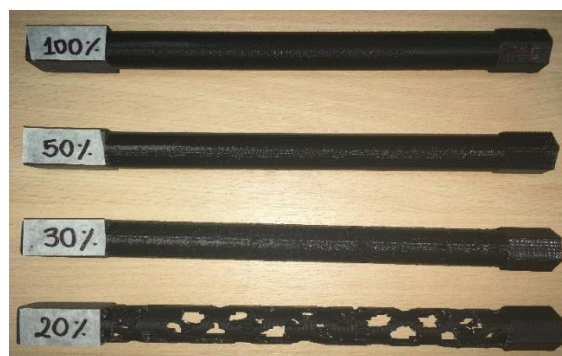
Figura 219 Prototipos impresos del cilindro a torsión con el 100%, 50%, 30% y 20% de masa, Material ABS y PLA
