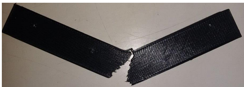
Figura 21 Probeta 2 de flexión ensayada, Material PLA
