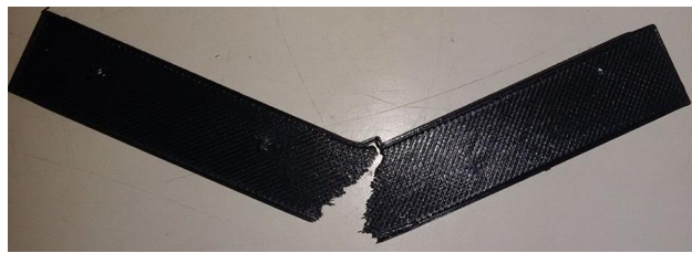
Figura 19 Probeta 1 de flexión ensayada, Material PLA
