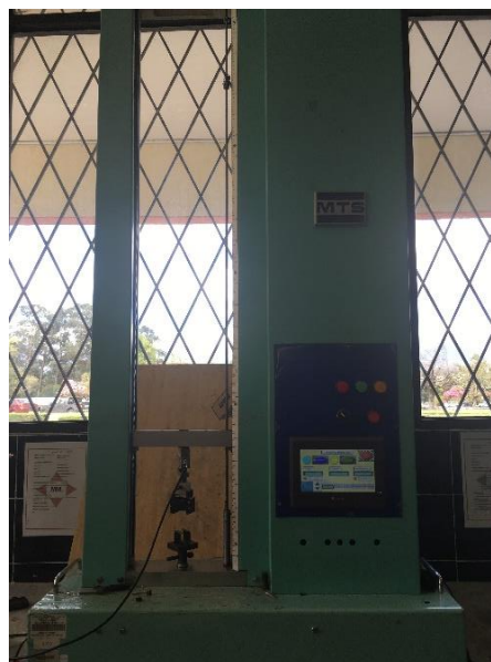
Figura 221 Máquinas de ensayos universales MTS, capacidad 5 KN
