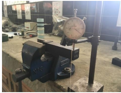
Figura 247 Ensayo de flexo torsión en el prisma cuadrado
