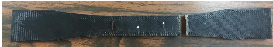
Figura 29 Probeta de Tracción Ensayada, Material ABS
