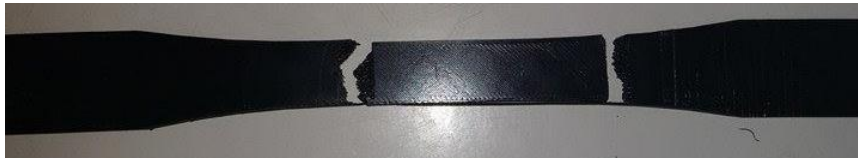
Figura 12 Probeta 1 Ensayada, Material PLA
