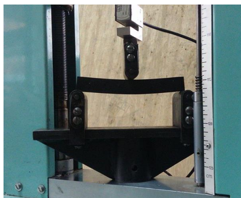
Figura 18 Ensayo de flexión, Material PLA
