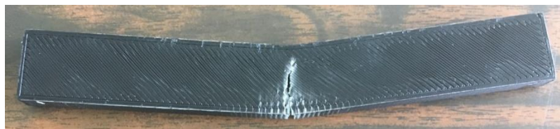
Figura 30 Probeta de Flexión Ensayada, Material ABS
