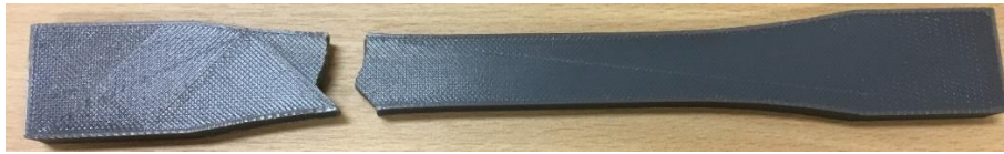
Figura 13 Probeta 2 ensayada, Material PLA
