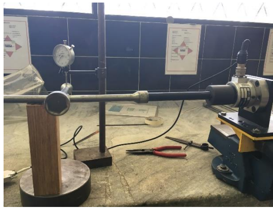
Figura 238 Ensayo de torsión en el elemento cilíndrico
