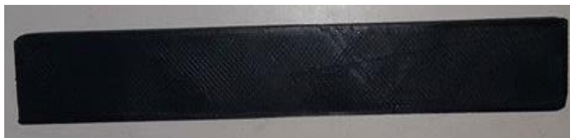
Figura 17 Probeta 1 de flexión, Material PLA
