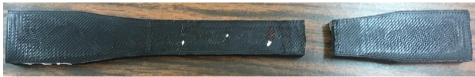
Figura 14 Probeta 3 ensayada, Material PLA
