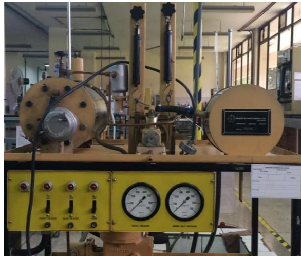
Figura 28 Motor a Vapor
