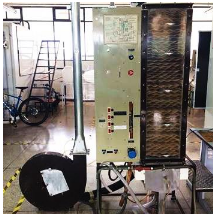
Figura 2 Torre de Enfriamiento
