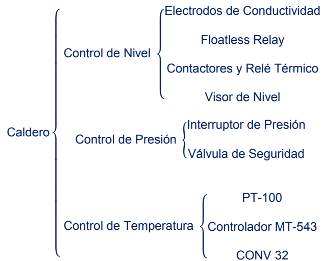
Figura 64 Sistemas de Control del Caldero
