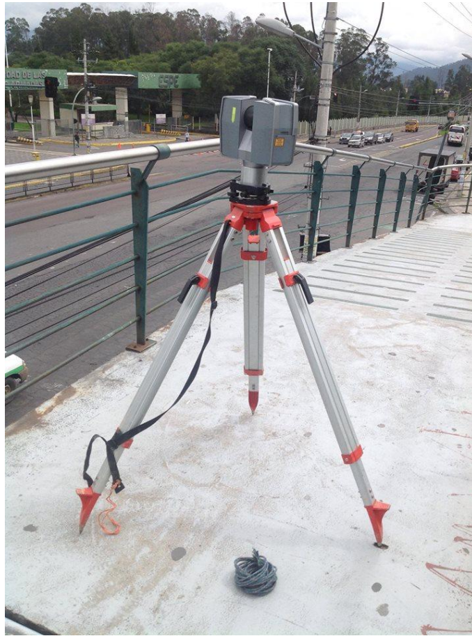
Figura 27 Plantación del equipo Trimble TX5 3D
