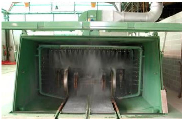
**Figura 19 Máquina de limpieza por aspersión automática**
