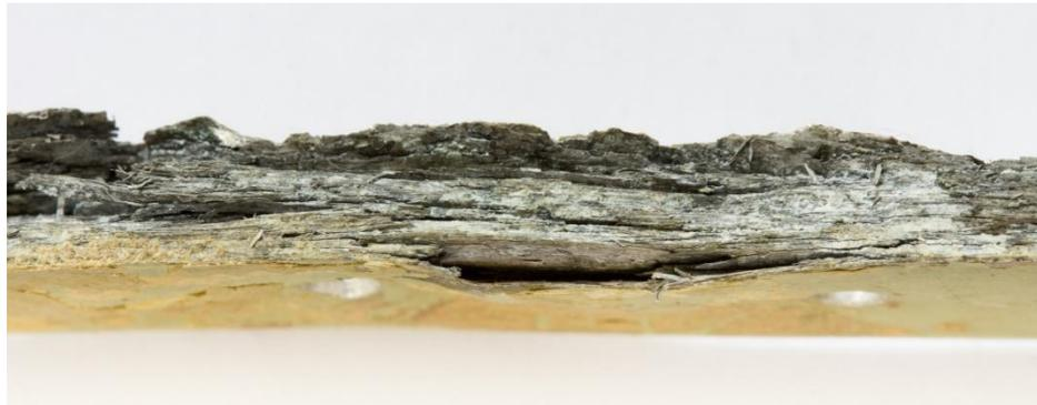
**Figura 15 Corrosión por exfoliación en una pieza de aluminio**
