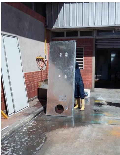
**Figura 4 Lavado manual de una plancha metálica**
