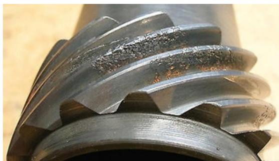
**Figura 14 Picadura en los dientes de un engrane helicoidal**
