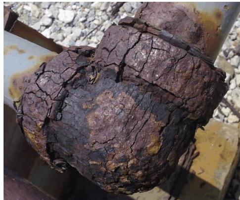
**Figura 12 Corrosión en codo por erosión**
