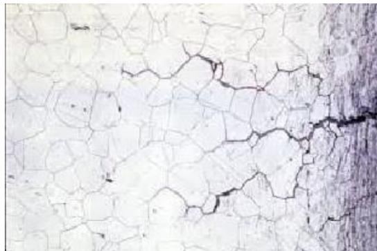
**Figura 17 Corrosión intergranular en acero inoxidable**
