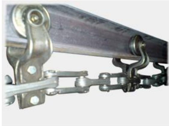
**Figura 51. Coche con sujeción a la cadena de manera permanente**
