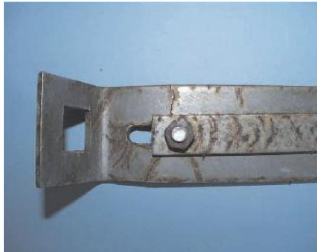
**Figura 13 Corrosión por agrietamiento**
