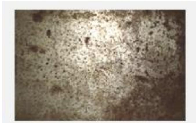
**Figura 21 Pieza metálica sin desengrasar**
