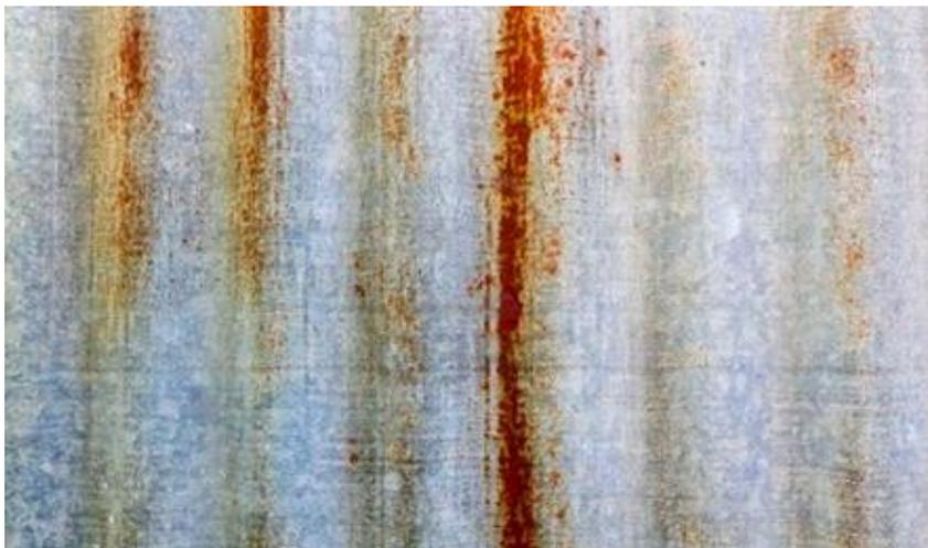
**Figura 8 Corrosión prematura en acero galvanizado**
