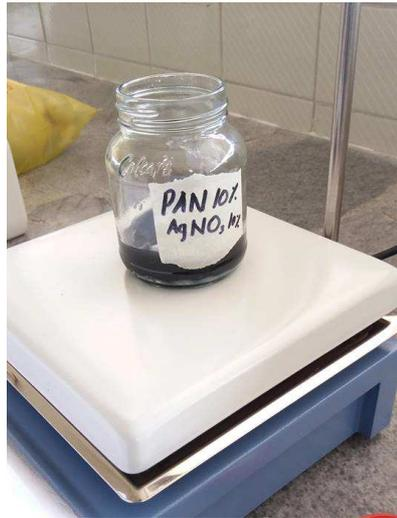
Figura 51. Solución de PAN y Ag NPs al 10% en peso de DMF
