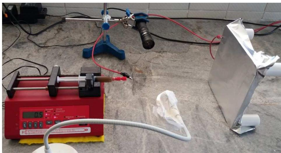
Figura 12. Solución PAN/DMF inyectada por el capilar hacia el colector mediante aplicación de voltaje
