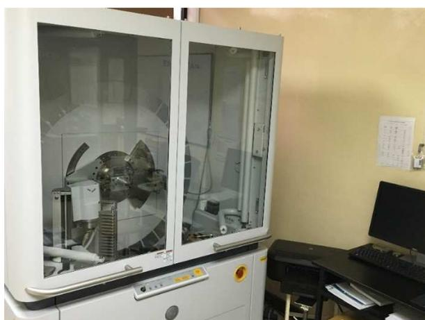
Figura 48. Difractómetro de rayos X, PANalytical
