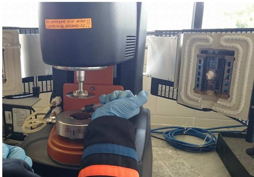
Figura 72. Análisis de la solución en el reómetro
