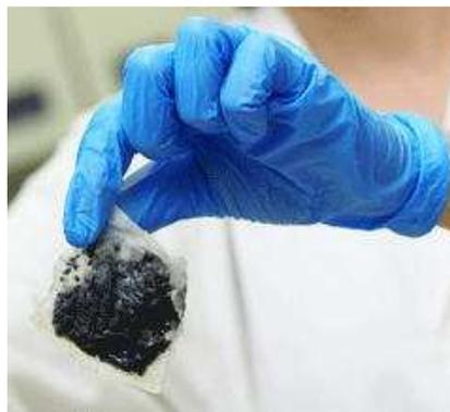
Figura 25. Membrana de filtro de agua mediante nanofibras
