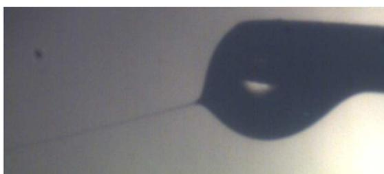
Figura 53. Solución de PAN 12% en DMF a 3,5 ml/h
