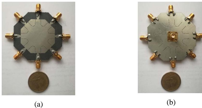
**Figura 78:** Divisor Radial 8 puertos sustrato RT Duroid 5880 (a) Vista Frontal (b) Vista posterior (c) Divisor Radial con conectores SMA
