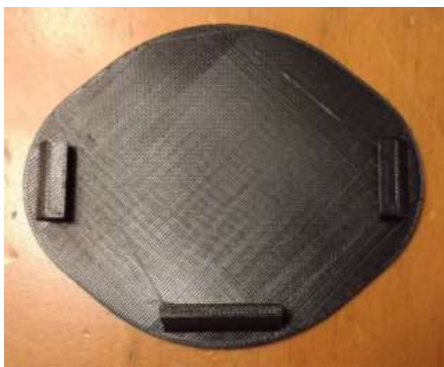
Figura 42. Impresión 3D de la base de soporte
