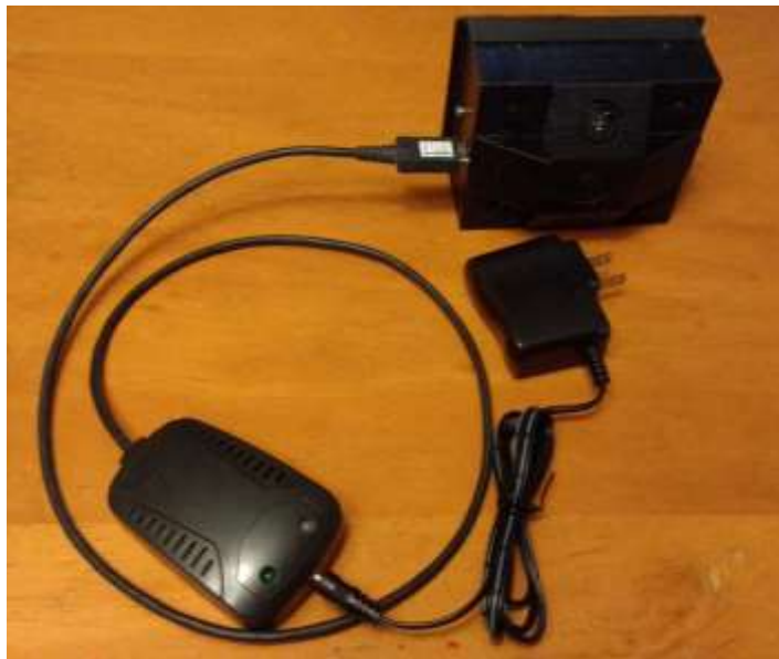
Figura 46. Cargador de pared y balanceador conectados al dispositivo electrónico.
