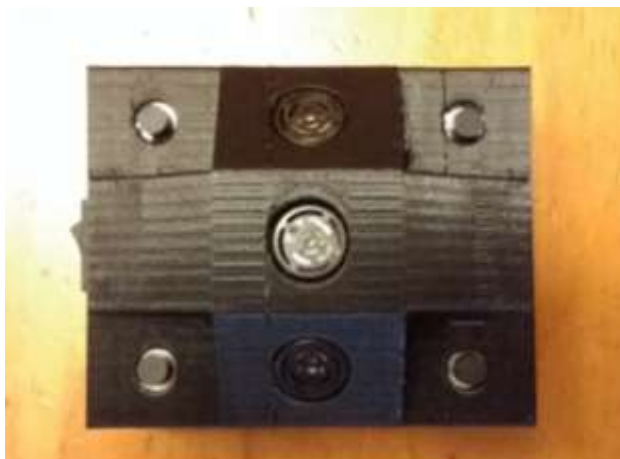
Figura 40. Impresión 3D de la carcasa frontal
