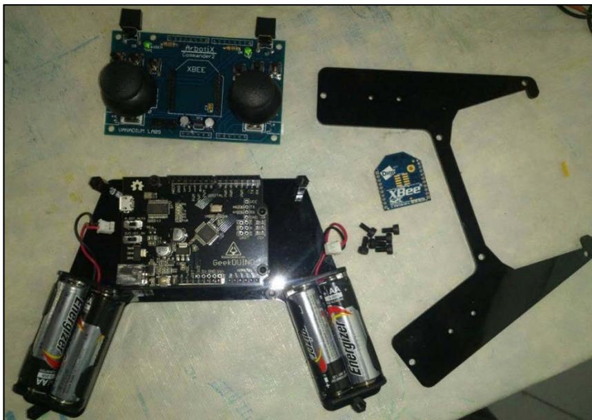
Figura 88: Componentes del joystick.
