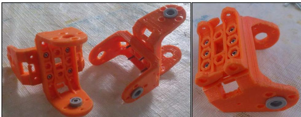
**Figura 73: Ensamblaje entre soportes.**
