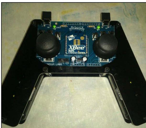
**Figura 63: Joystick del robot hexápodo.**
