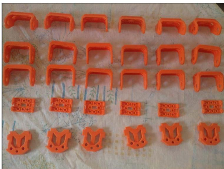
**Figura 68: Soportes para motores y pies.**
