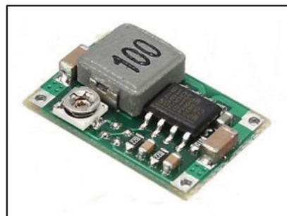
**Figura 56: Módulo convertor DC-DC.**
