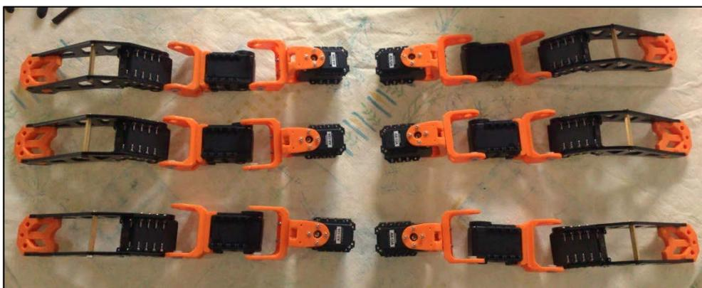
**Figura 79: Disposición de los eslabones en las extremidades.**
