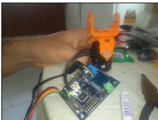
Figura 76: Conexión de servomotor.
