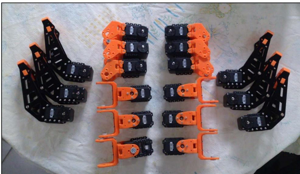
**Figura 78: Soportes ensamblados a servomotores.**
