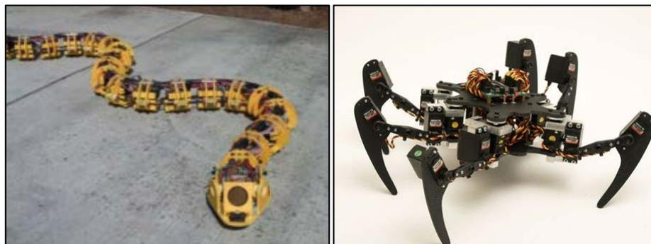
**Figura 7: Robot no caminante (izq.) y caminante (der.).**
