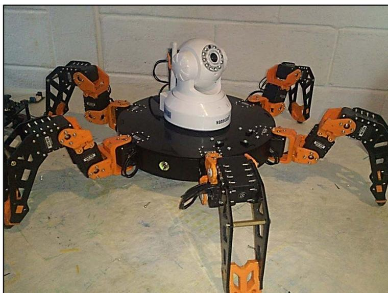
**Figura 83: Robot hexápodo ensamblado.**
