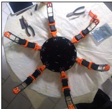
**Figura 81: Ensamblaje de las extremidades a la base del cuerpo.**
