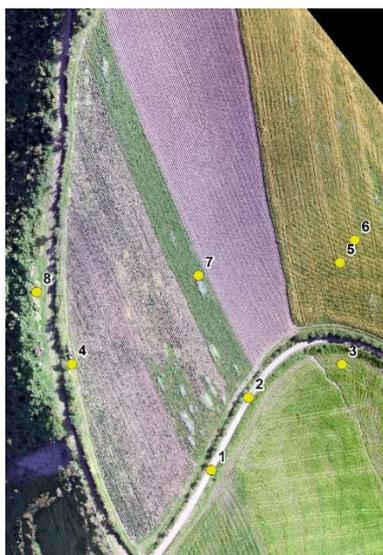
**Figura 65: Puntos de apoyo sobre ortomosaico RGB**
