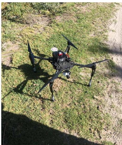
**Figura 57: UAV DJI Matrice 100**
