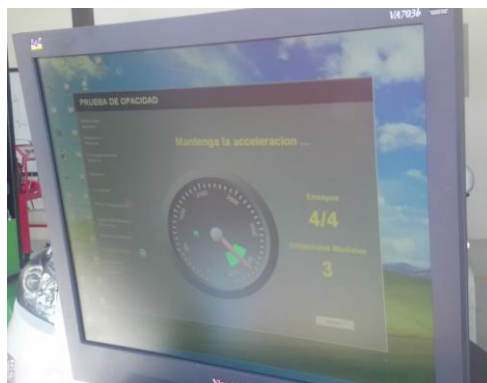
Figura 61. Pantalla prueba opacímetro CARTEK
