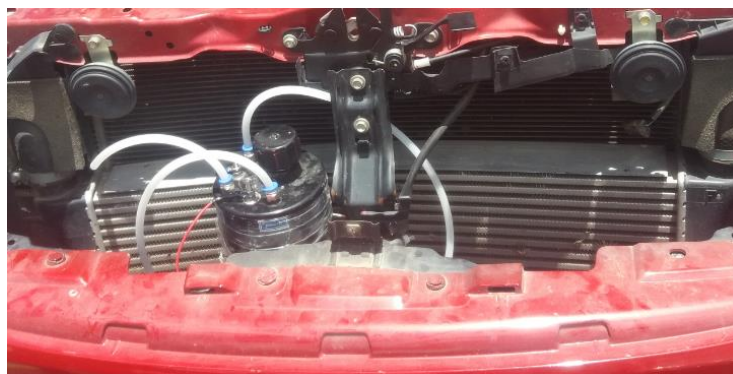
Figura 40. Generador de hidrógeno implementado en el vehículo
