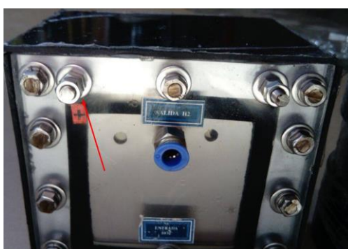
Figura 29. Borne positivo del generador de hidrógeno
