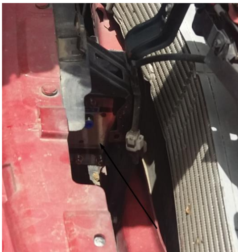
Figura 20. Ubicación generador de hidrógeno en la camioneta
