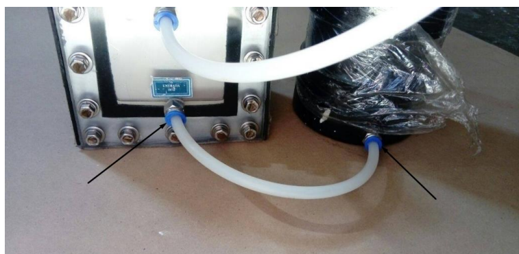
Figura 22. Conexión manguera “H 2 O” del depósito al generador de hidrógeno
