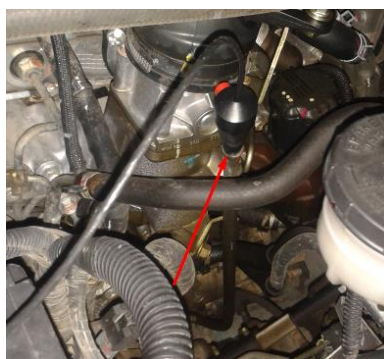
Figura 65. Ubicación medidor de temperatura del módulo GPRPM-300
