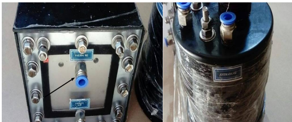
Figura 24. Conexión manguera “Salida O2” del depósito al generador de hidrógeno
