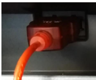
Figura 73. Conexión del OBDLink SX al vehículo
