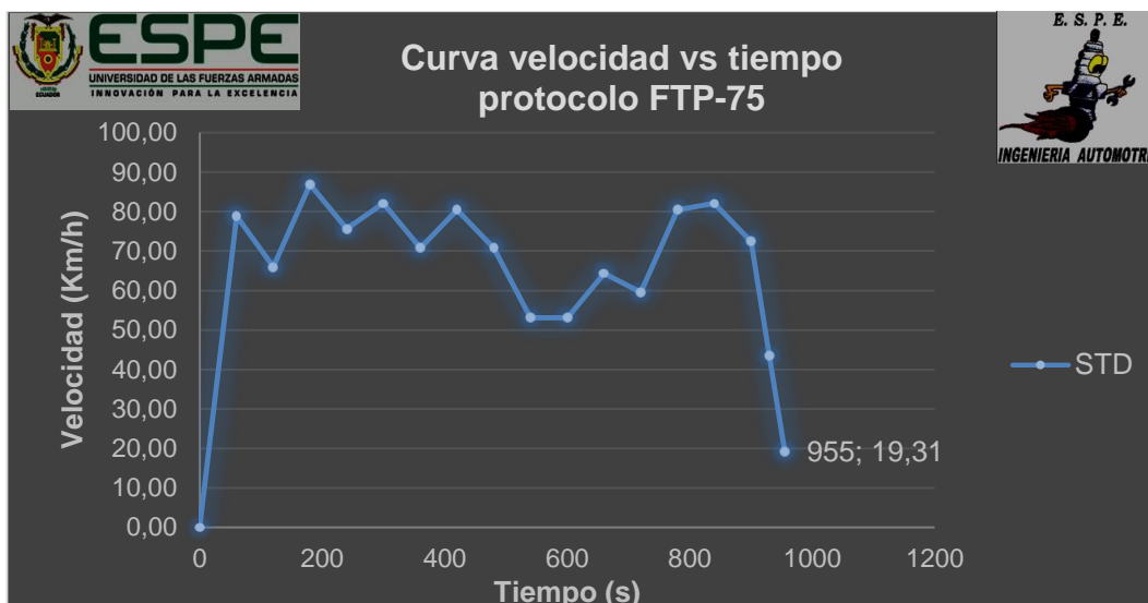
Figura 116. Protocolo FTP-75 motor estándar curva velocidad vs tiempo
