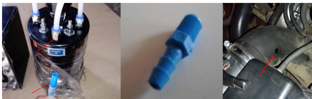
Figura 25. Conexión manguera “Al motor H2” del depósito al múltiple de admisión
