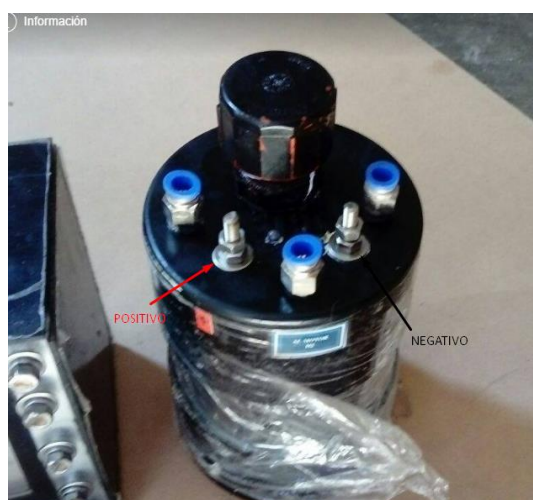
Figura 31. Bornes positivo y negativo del depósito del generador de hidrógeno
