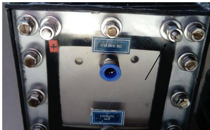
Figura 30. Borne negativo del generador de hidrógeno
