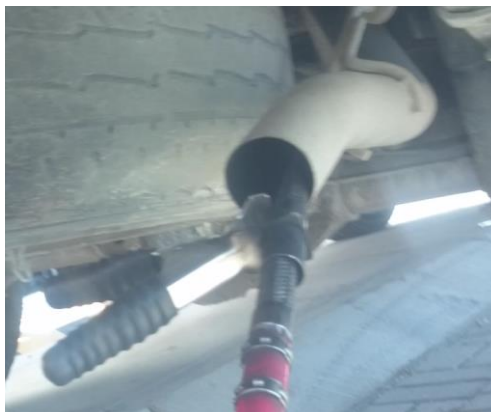
Figura 60. Sonda en el tubo de escape opacímetro CARTEK
