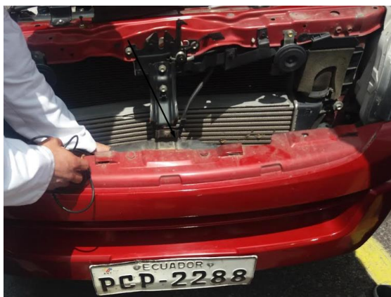
Figura 18 Lugar de instalación generador de hidrógeno
