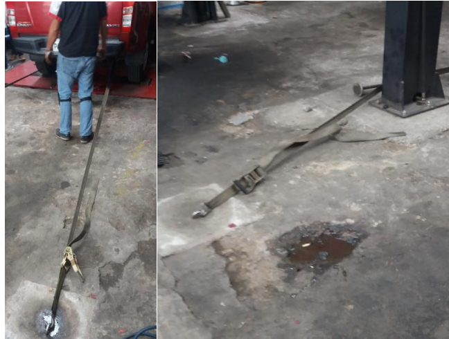
Figura 48. Anclaje del vehículo en puntos fijos
