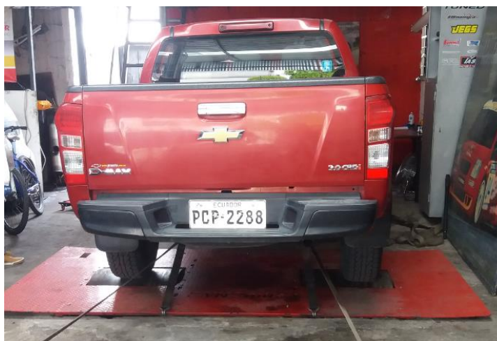
Figura 9. Dinamómetro de chasis Dynomite
