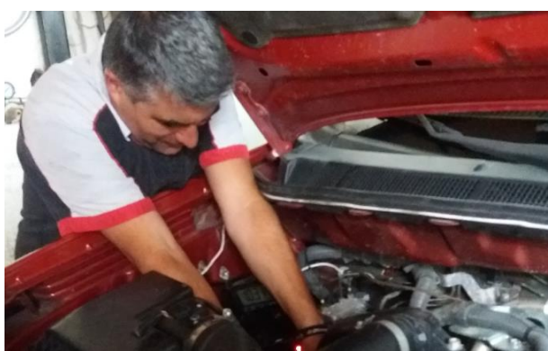
Figura 51. Conexión de la manguera de vacío al vehículo
