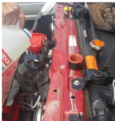
Figura 39. Llenado de electrolito en el depósito del generador de hidrógeno
