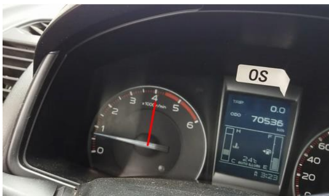
Figura 54. Rango de revoluciones de prueba de dinamómetro
