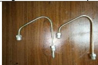
Figura 34. Cañerías alta presión
