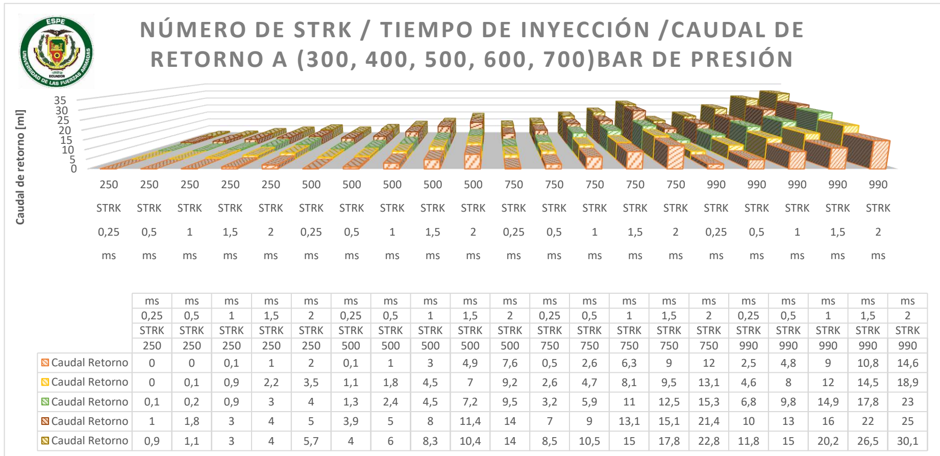
Figura 141. Análisis grafico de los caudales de retorno, con variación del tiempo de inyección y numero de SRTK a (300, 400, 500, 600, 700) bar de presión, en baso a los datos de la tabla 57.
