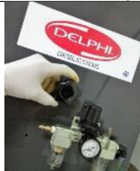
Figura 73 Válvula master control de presión
