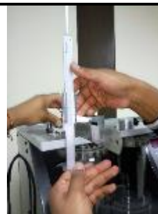
Figura 122 Traslación de medidas al cilindro de pulverización
