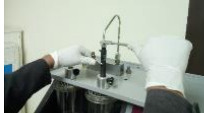
Figura 77. Cañería de alimentación.
