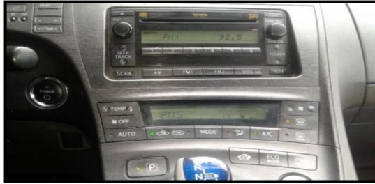
**Figura 108 Panel de control del aire acondicionado**
