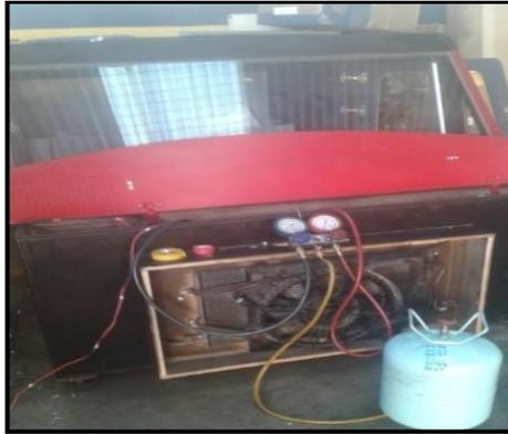
**Figura 126 Carga del refrigerante**
