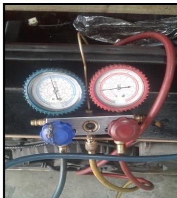
**Figura 34 manómetros de presión.**
