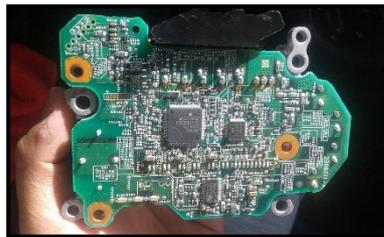
**Figura 7 Placa de control del compresor trifásico.**
