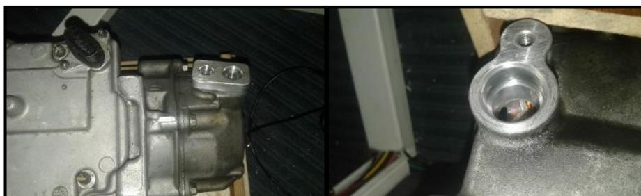
**Figura 63 Conexión de tuberías al compresor del banco simulador**
