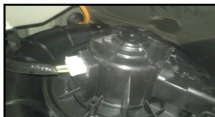
**Figura 99 Pines del motor del soplador**
