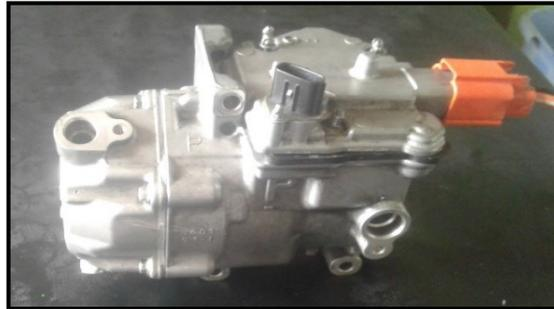
**Figura 3 Compresor del Toyota modelo Prius 2010.**
