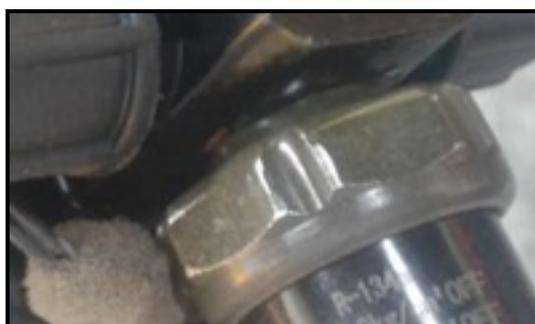
**Figura 59 Filtro deshidratador del banco simulador**
