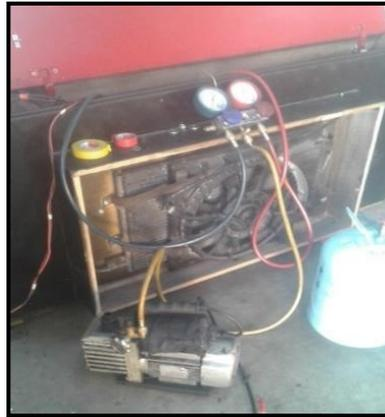
**Figura 124 Vacío del sistema de aire acondicionado**
