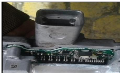
**Figura 107 Placa de control del compresor**
