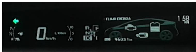
**Figura 130 Indicador del módulo de energía del Toyota prius**
