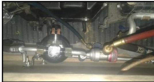
**Figura 127 Conexión de la válvula de alta presión**
