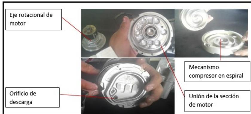
**Figura 5 Sección de compresión.**
