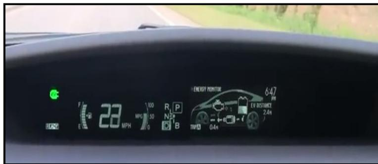
**Figura 134** monitoreo de la batería en aceleración
