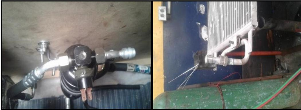
**Figura 66 Filtro de humedad y condensador**
