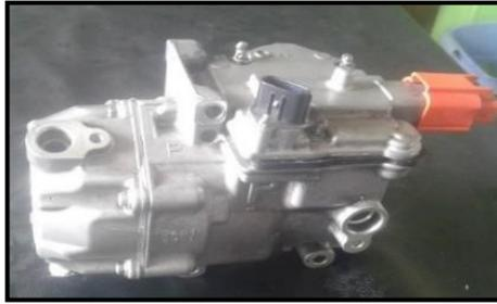
**Figura 106 Compresor de aire acondicionado**
