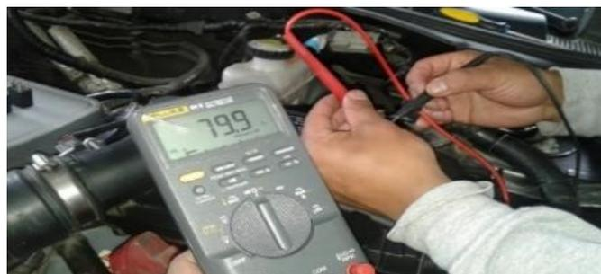
**Figura 87 Relé del ventilador del A/C, Ford Scape**
