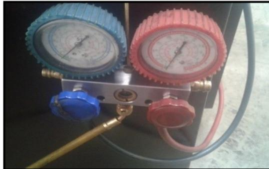
**Figura 129 Cierre de las válvulas de alta y baja presión**
