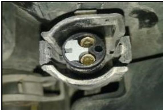
**Figura 95 Pines de conexión del sensor de temperatura**
