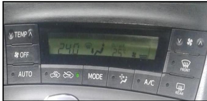
**Figura 40 Control del sistema de aire acondicionado**
