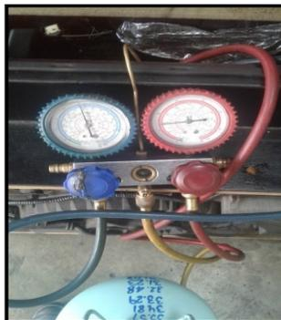
**Figura 128 válvulas de alta y baja presión.**
