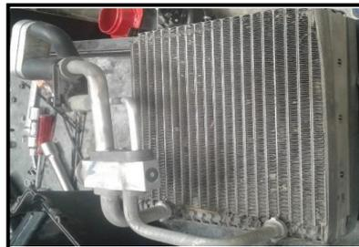
**Figura 55 Selección del evaporador del banco de simulación**
