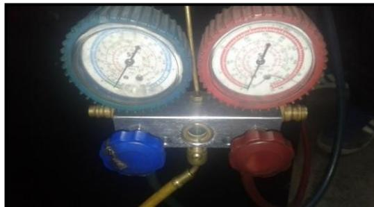
**Figura 125 Manómetros de alta y baja presión**
