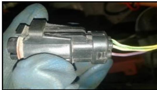
**Figura 96 Pines de conexión del sensor de presión**
