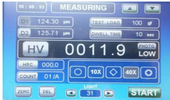
Figura 41. Ensayo de microdureza realizado a la resina cerámica
