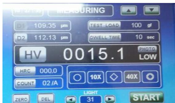
Figura 39. Ensayo de microdureza realizado a la resina fotopolimérica
