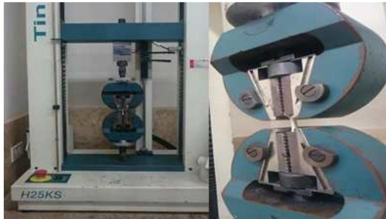
Figura 38. Equipo de tracción para ensayo
