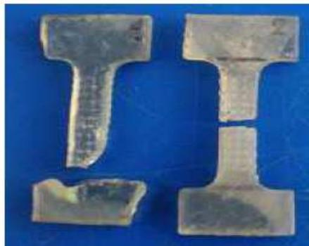
Figura 40. Probeta resina fotopolimérica después de ensayo de tracción
