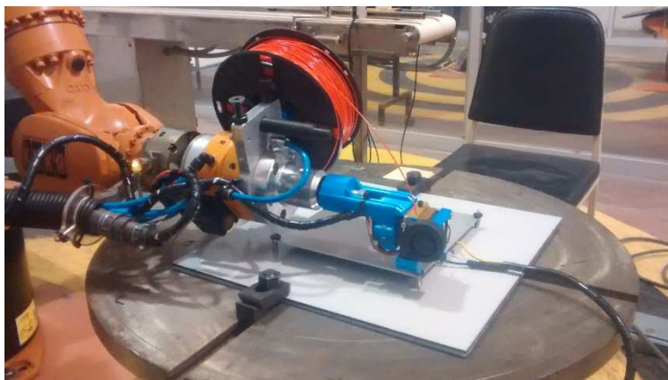
Figura 50 Acoplamiento al robot del sistema de extrusión.
