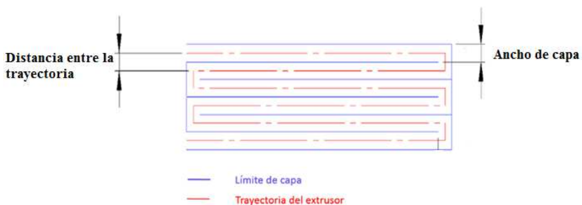
Figura 28 Representación de la estrategia de deposición en zigzag
