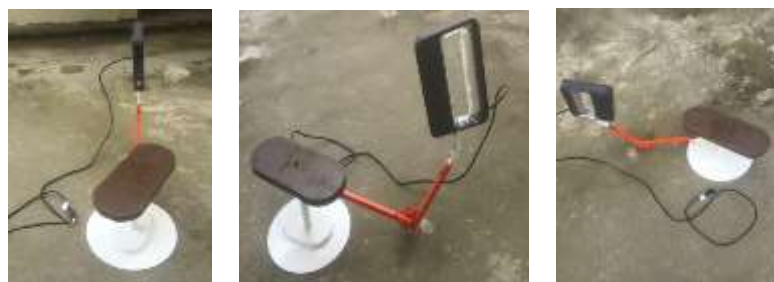
Figura 9. Trípode Adaptado para el escáner 3D
