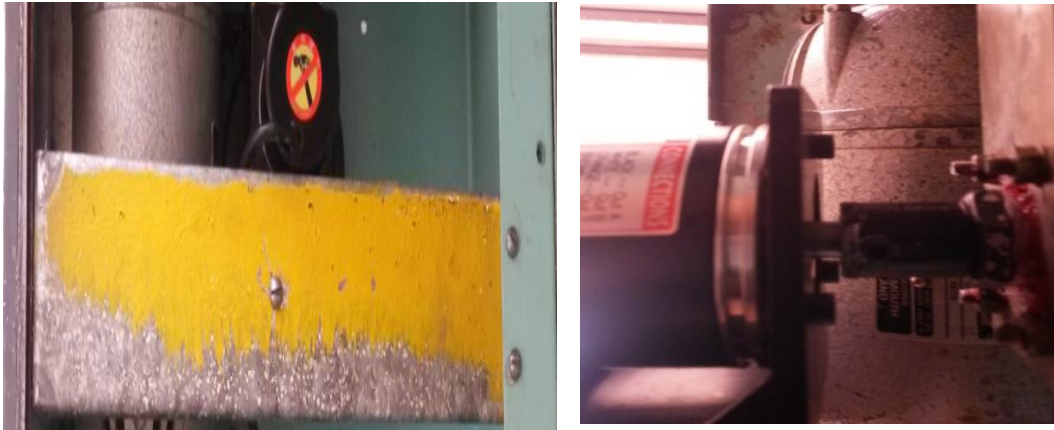
Figura 27 Implementación del mecanismo de sostén para el sensor de desplazamiento.
