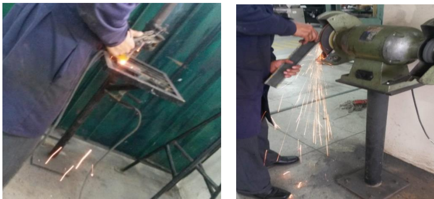
Figura 26 Construcción del mecanismo de sostén para el sensor de desplazamiento.
