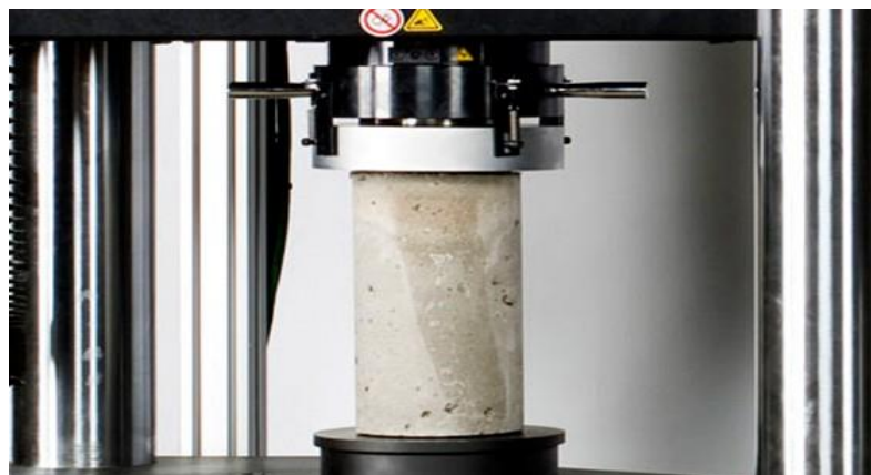
Figura 11 Ensayo de compresión del hormigón
