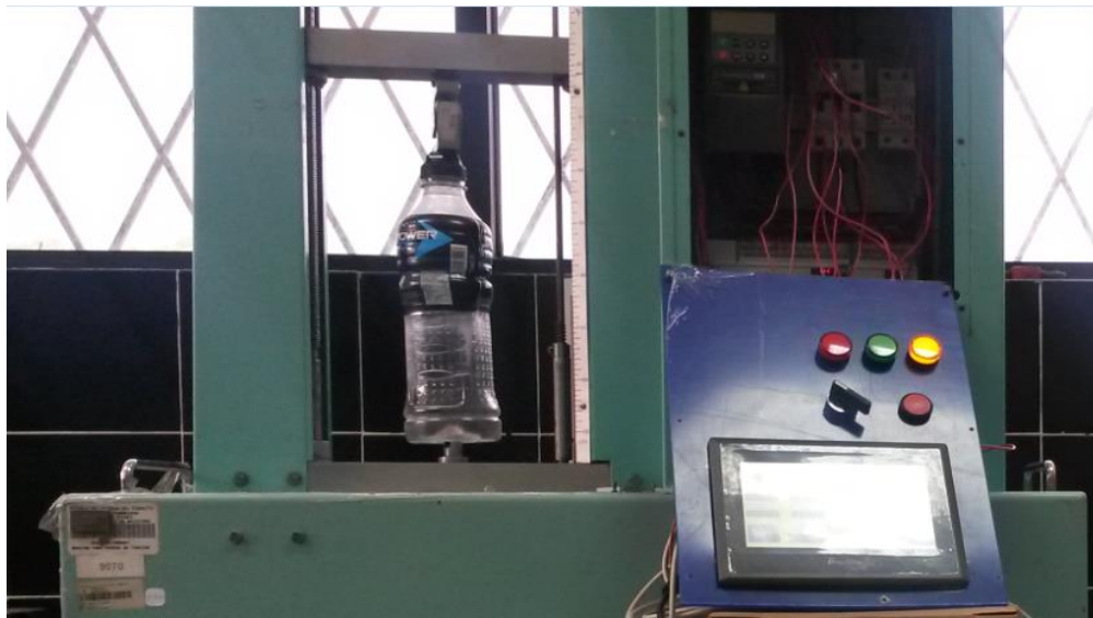
Figura 18 Ensayo de tracción-compresión de un polímero.
