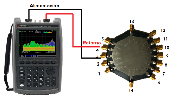
Figura 55. Esquema medición aislamiento Puerto 3 respecto a Puerto 2.
