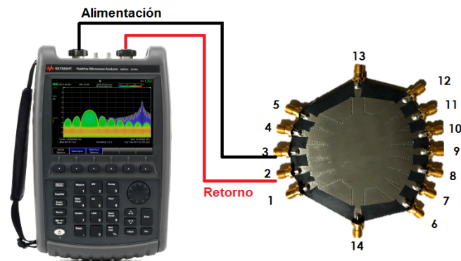
Figura 55. Esquema medición aislamiento Puerto 3 respecto a Puerto 2.
