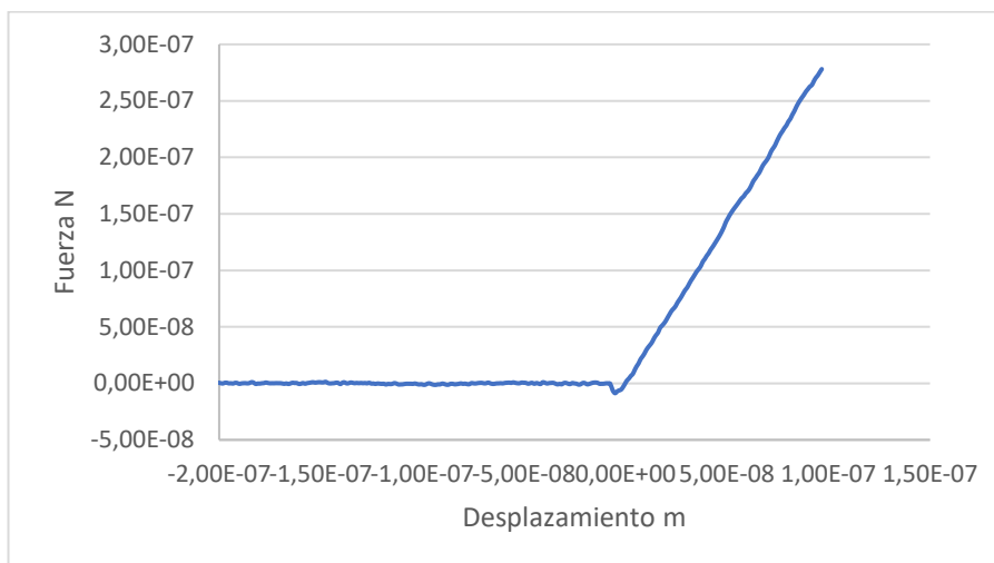
Figura 39 Curva de Fuerza para fibras de etanol y PVP al 8% obtenidas del Microscopio AFM
