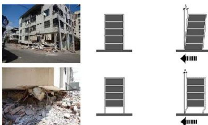
Figura 16 Discontinuidad de resistencia
