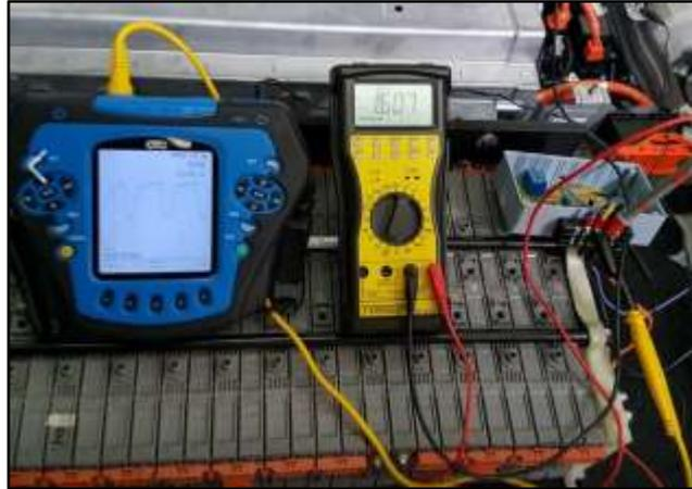
**Figura 79. Prueba de funcionamiento del módulo del sensor app**
