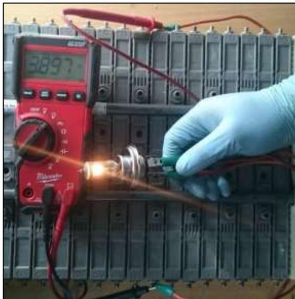
**Figura 36. Descarga de las celdas de la batería de alta voltaje.**
