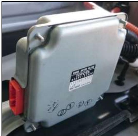
**Figura 11. Ecu de la Batería de alta voltaje**
