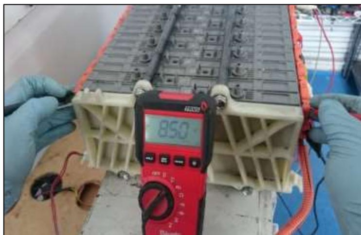
**Figura 39. Voltaje nominal de la celda con el 20 % de tolerancia de carga.**
