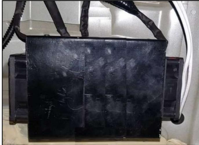
**Figura 70. Módulo de cargador**
