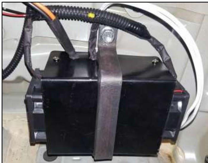
**Figura 88. Ubicación del módulo del cargador en el vehículo**
