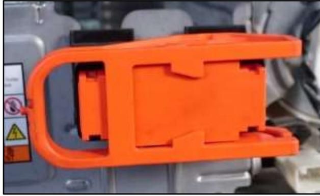
**Figura 13. Jumper de Seguridad**
