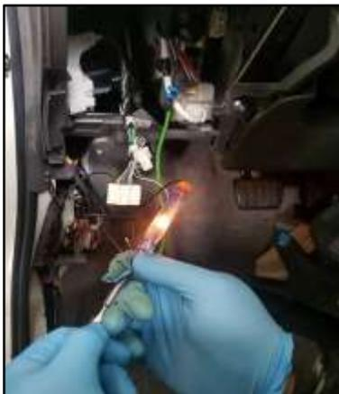
**Figura 85. Señal de 12V en contacto**
