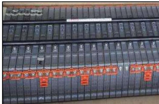
**Figura 17. Baterías de níquel-hidruro metálico**
