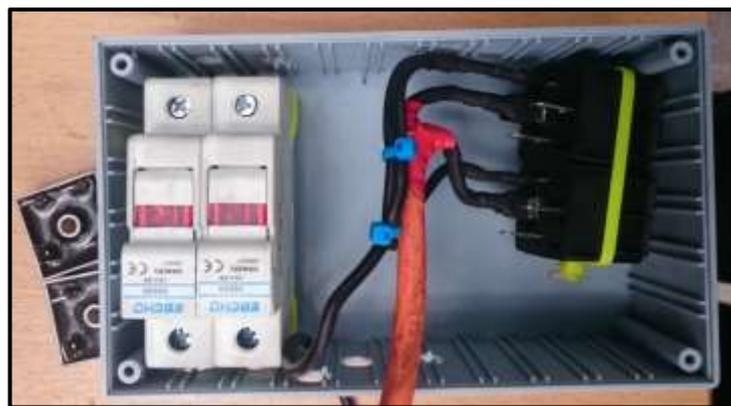
**Figura 67. Conexión del módulo de conmutación del positivo**
