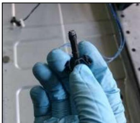
**Figura 10. Sensor de temperatura de la batería de alto voltaje.**
