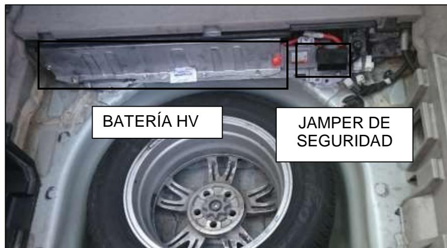
**Figura 30. Ubicación de la batería de alta tensión.**
