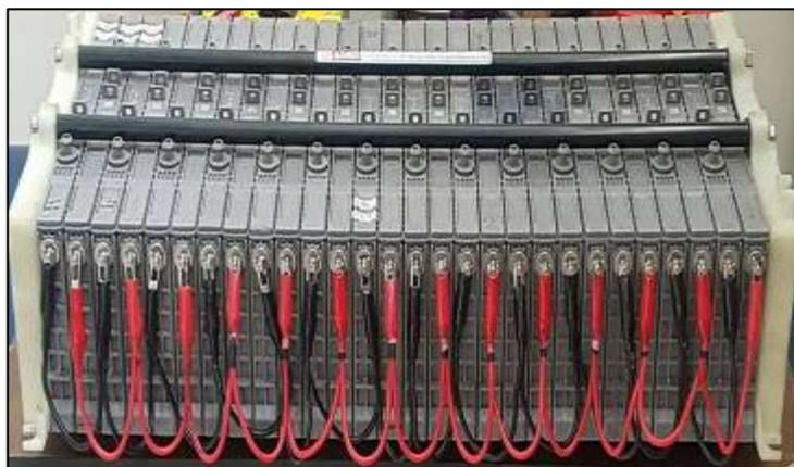
**Figura 43. Conexión de las celdas para la ecualización de la batería de alto voltaje.**
