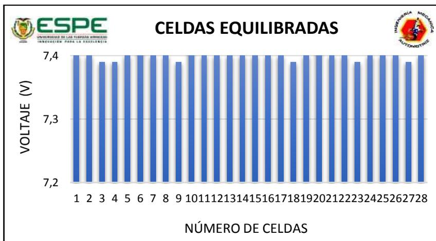
**Figura 44. Voltaje de celdas equilibradas**
