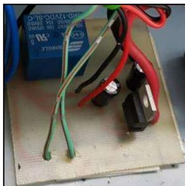
**Figura 58. Componentes del circuito de seguridad**
