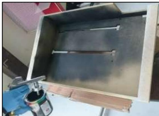
**Figura 74. Aplicación del recubrimiento**
