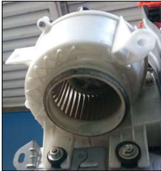
**Figura 12. Ventilador del sistema de enfriamiento de la batería HV**
