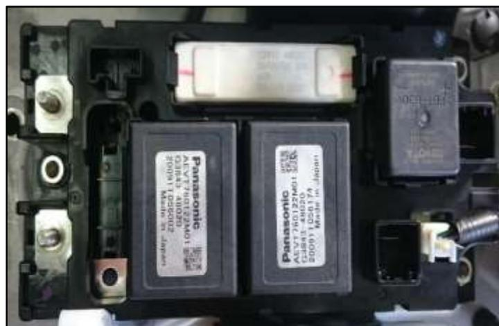
**Figura 14. Conjunto de relés de activación.**
