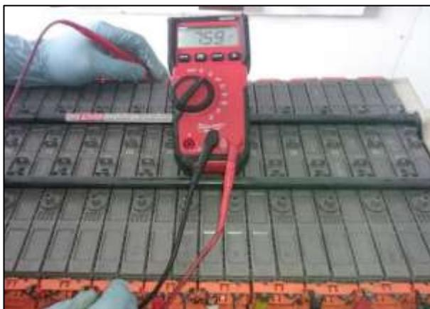
**Figura 41. Voltaje nominal de la celda en el proceso de descarga de la batería.**
