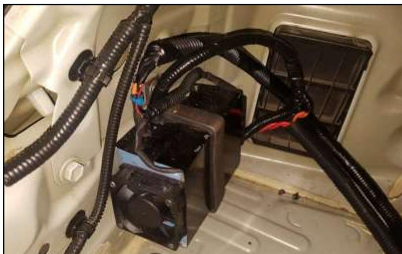
**Figura 89. Aislamiento de los cables del cargador**
