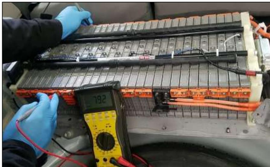
**Figura 31. Voltaje nominal de las celdas de la batería de alta tensión**
