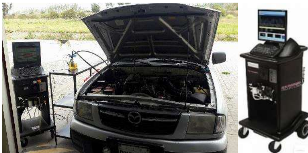
Figura 11. Conexión vehículo y analizador de gases CARTEK
