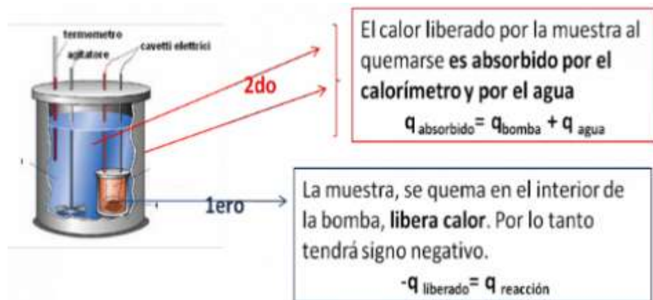
Figura 5. Comportamiento en el interior de la bomba calorimétrica Fuente: (Cedrón, Landa, & Robles , 2011)
