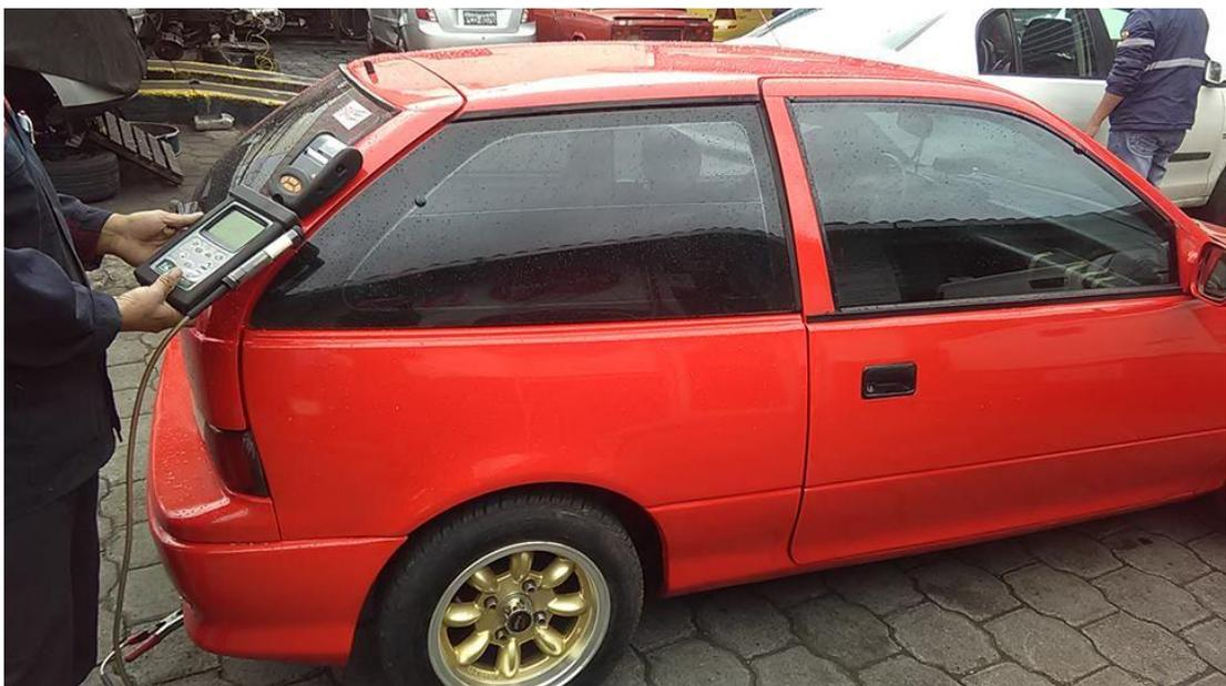
**Figura 101. Encender equipo analizador de gases.**
