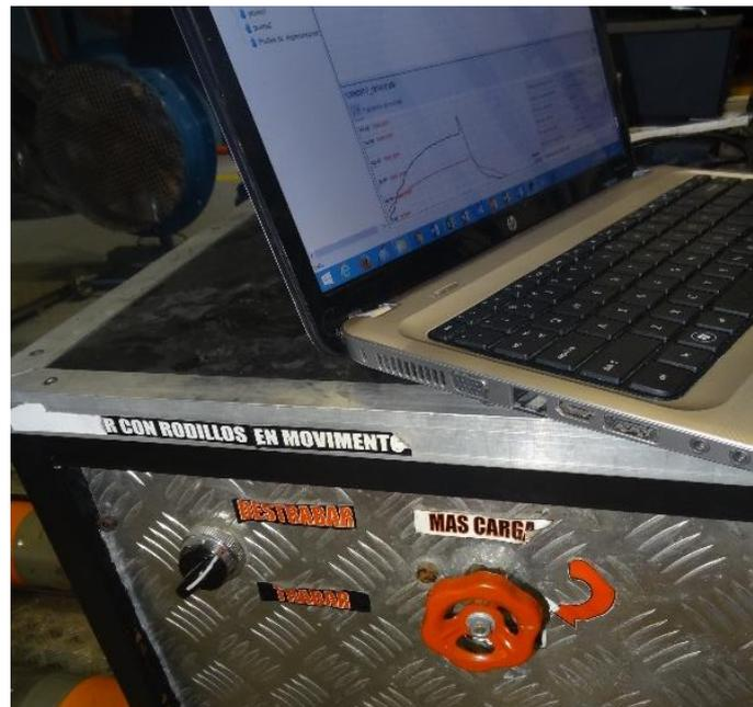
**Figura 92. Aplicación de carga en el dinamómetro**
