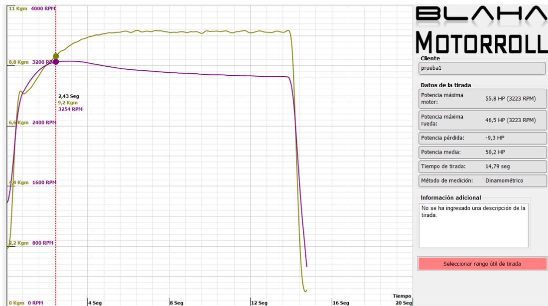
Figura 114. BLAHA MOTORROLL – Curva de torque del motor Suzuki 1300 estándar
