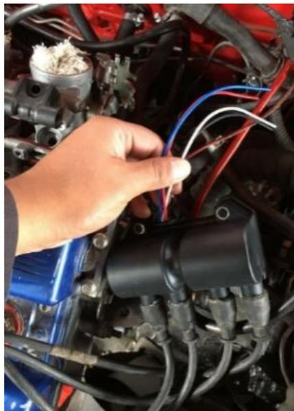
**Figura 52. Conexión de salidas del módulo de control**
