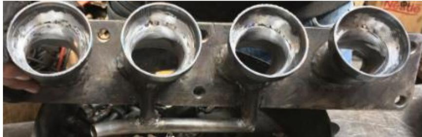
**Figura 5. Diseño del colector de admisión para el motor Suzuki 1300**
