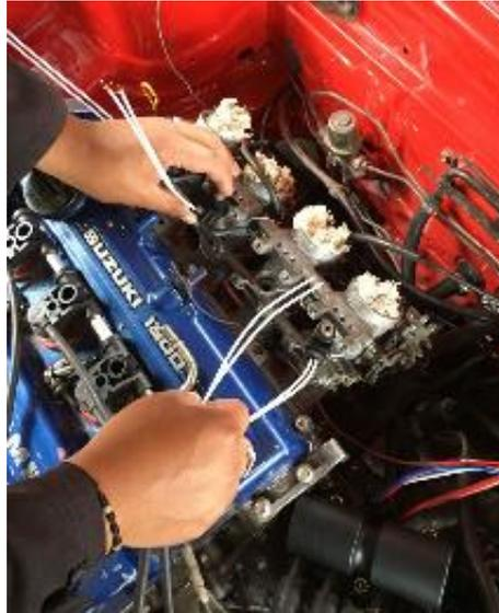
**Figura 49. Conexión de inyectores**
