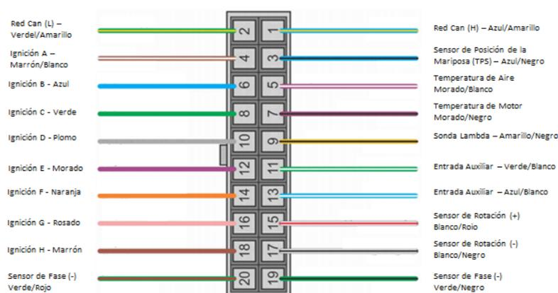
**Figura 44. Guía de instalación de TPS conector B**
