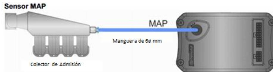
**Figura 37. Sensor MAP ubicado en la parte trasera del módulo**
