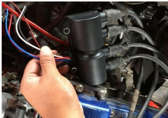
**Figura 22. Bobina de encendido DIS**
