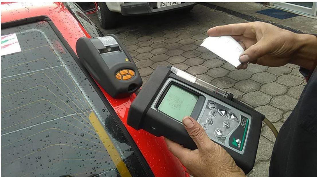
**Figura 105. Impresión de los análisis de gases**
