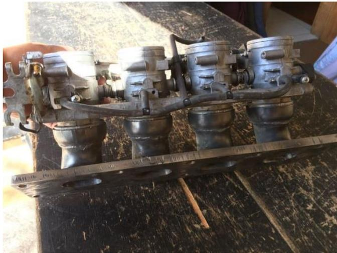
**Figura 31. Ensamble ITB – colector de admisión**
