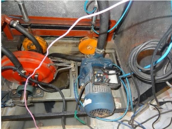
**Figura 91. Verificación de circulación de agua en el freno hidráulico**
