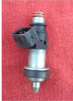
**Figura 20. Inyectores alta resistencia**
