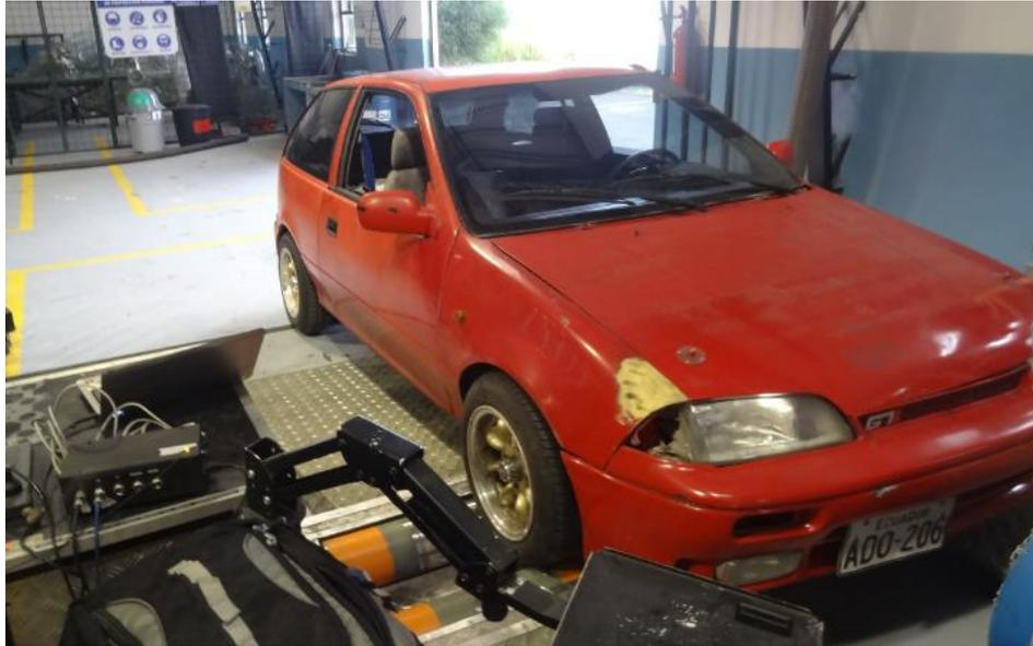
**Figura 88. Vehículo centrado en el banco dinamométrico**
