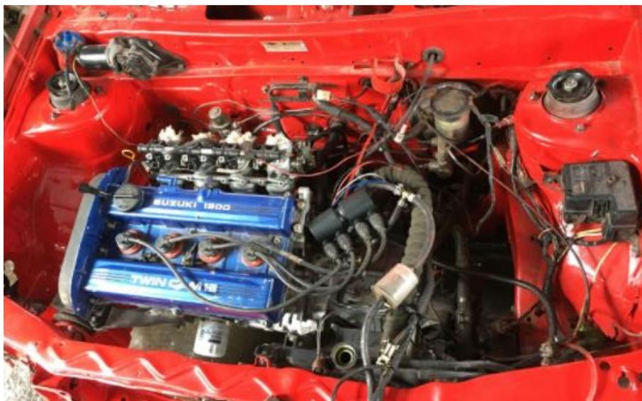
**Figura 33. Motor Suzuki 1300 implementado sistema ITB**
