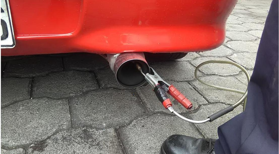
**Figura 102. Colocar la sonda del analizador de gases.**
