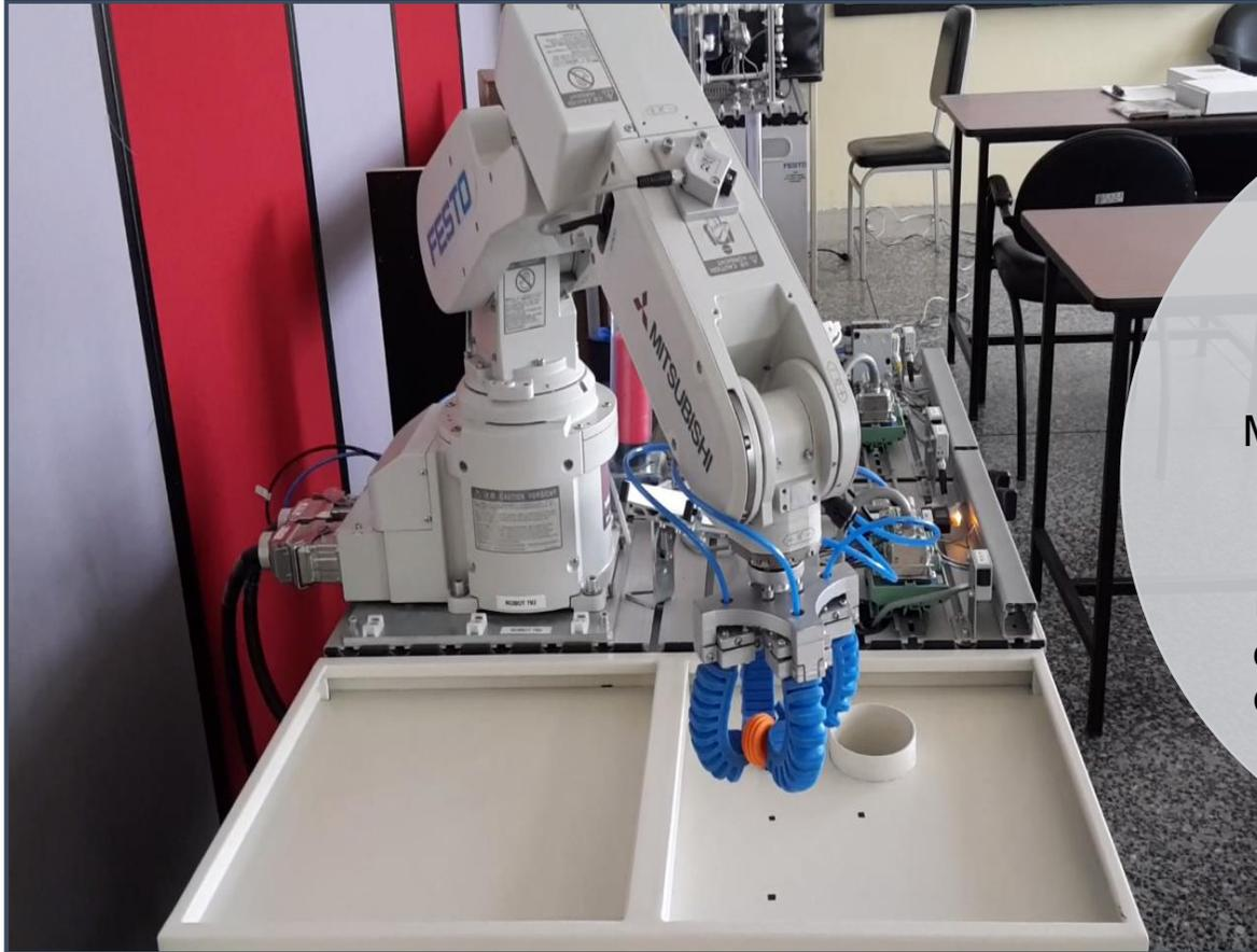
Este trabajo de titulación consiste en usar la tecnología de robótica blanda, para diseñar e implementar un sistema Mecatrónico de manipulación de objetos con geometrías irregulares, en el brazo robótico Mitsubishi de la universidad, además consta de un módulo destinado a la clasificación de cada uno de los objetos manipulados.
