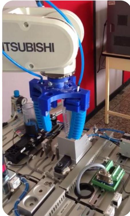
Primeras pruebas de interacción entre actuador blando y brazo robótico
