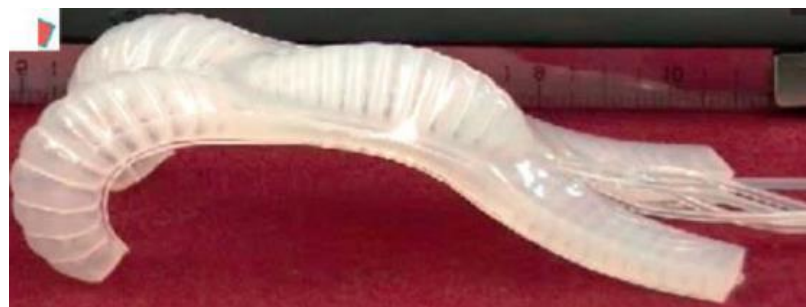
Figura 12 Robot blando accionado por aire comprimido
