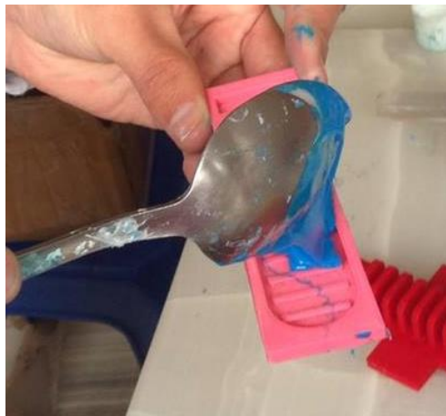
Figura 89 Relleno de molde capa inferior flexible
