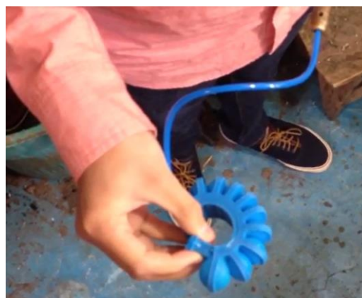
Figura 123 Pruebas finales del actuador blando presurizado
