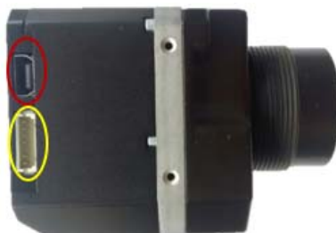
Figura 17 Puerto Mini USB (Rojo), Conector de control mediante telemetría (amarillo)
