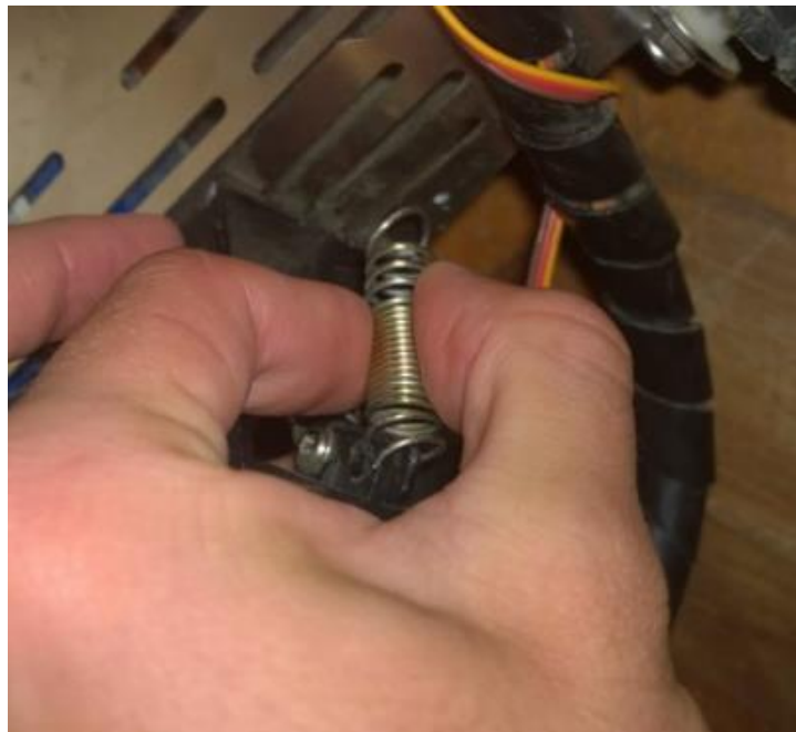
Figura 23 Ubicación del resorte en la parte Inferior
