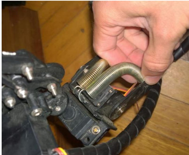
Figura 24 Ubicación del resorte para soportar el acople y bobina
