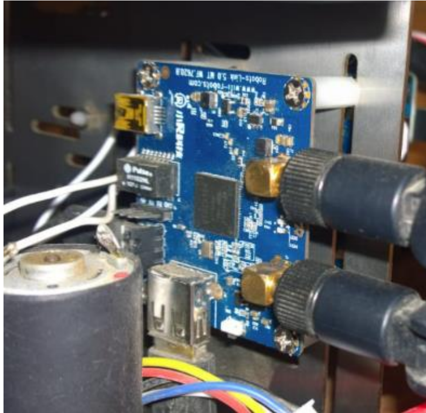
Figura 48 Ubicación del módulo WiFi
