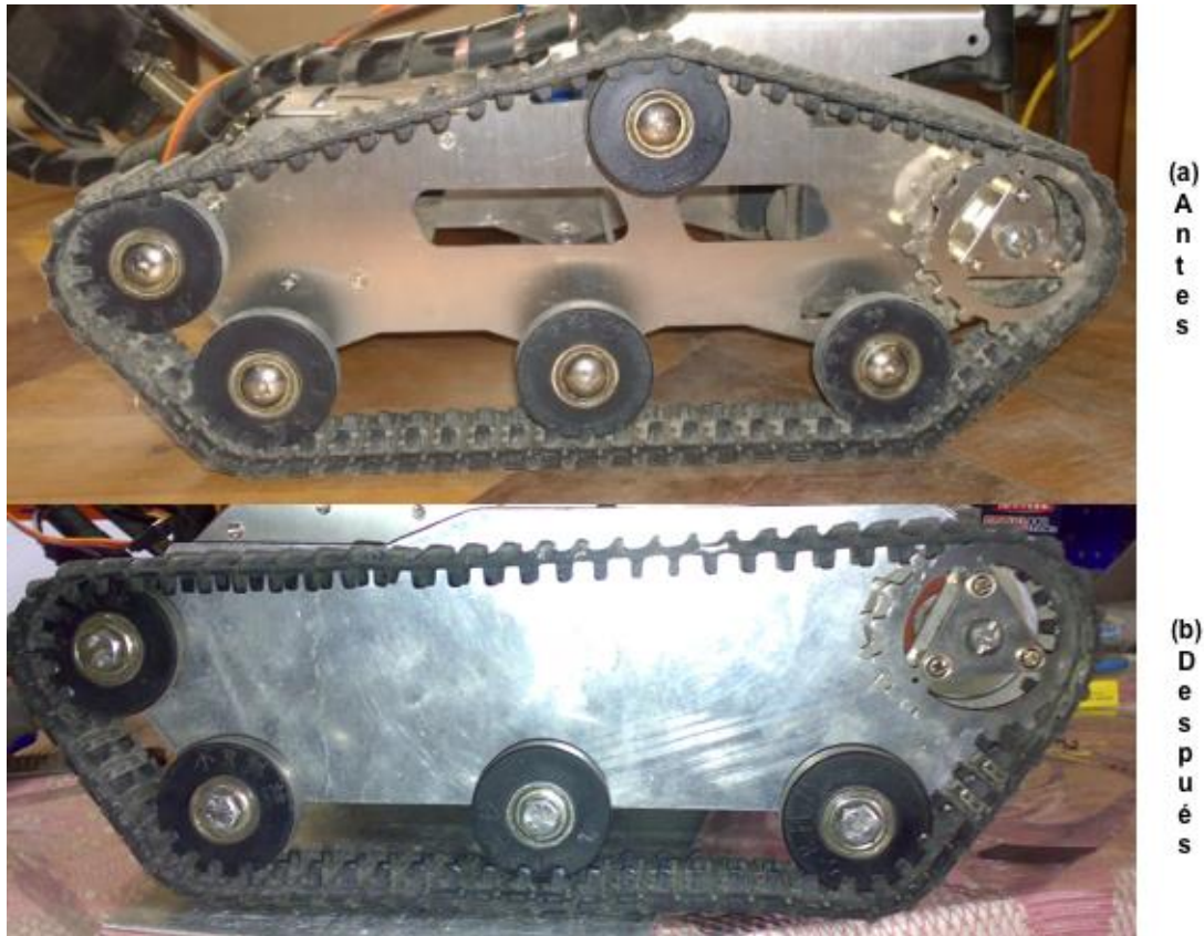
Figura 41 Cambio de la distribución de las orugas
