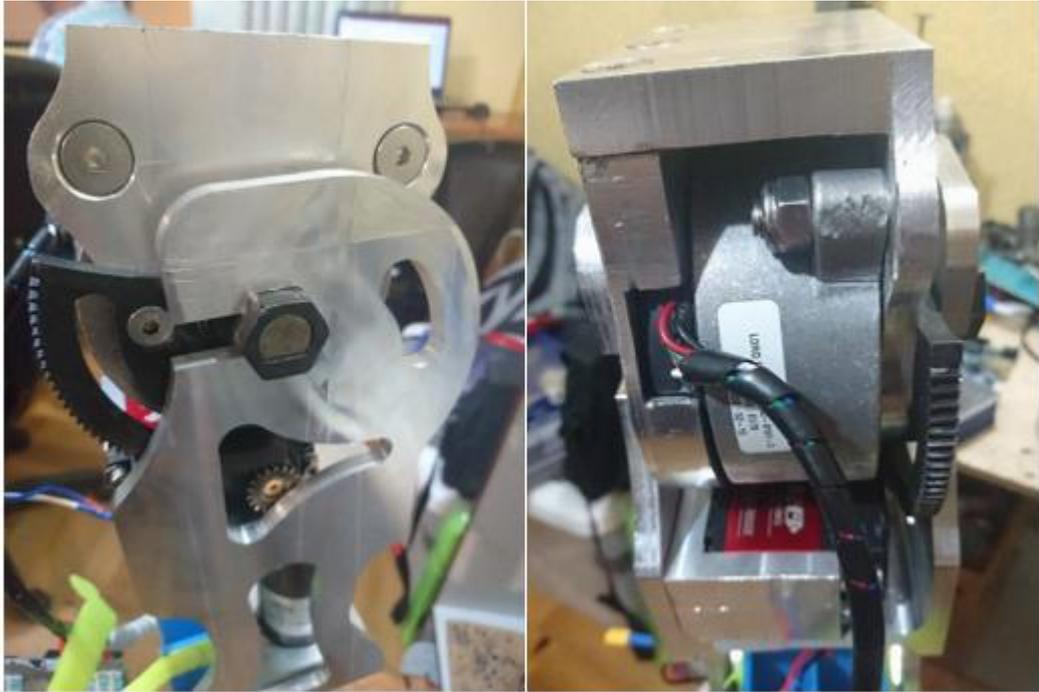
**Figura 94 Sistema de transmisión y bloqueo de la articulación**
