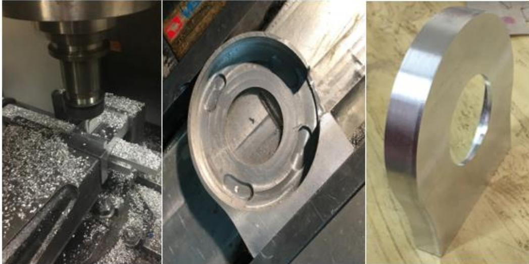
**Figura 83 Mecanizado de la tapa del limitador de torque**
