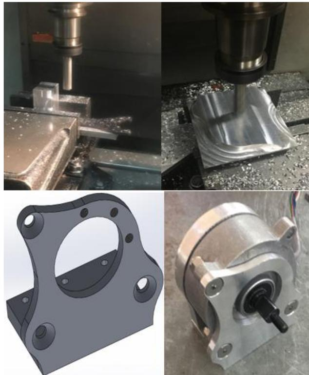
**Figura 84 Mecanizado y ensamble del soporte del limitador de torque**
