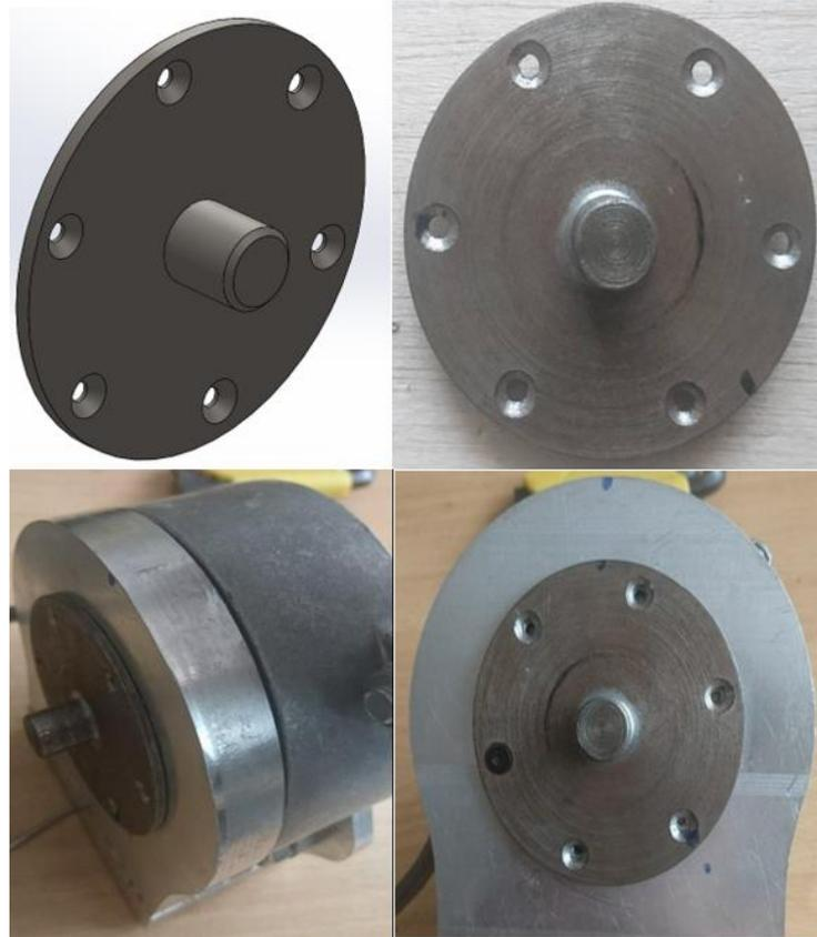
**Figura 86 Mecanizado de la Manzana**
