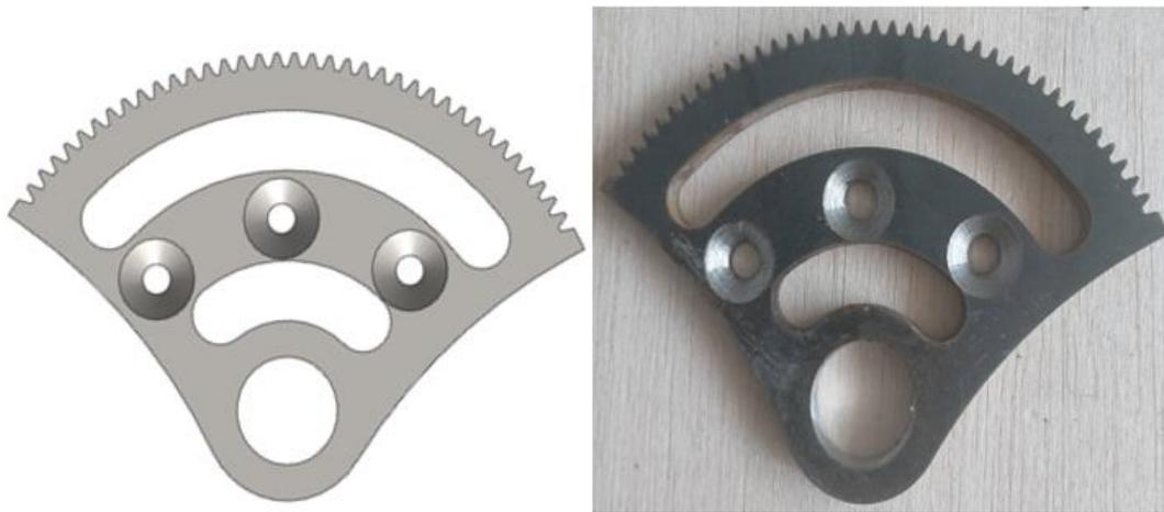
**Figura 80 Corte por chorro de agua del engrane conducido**
