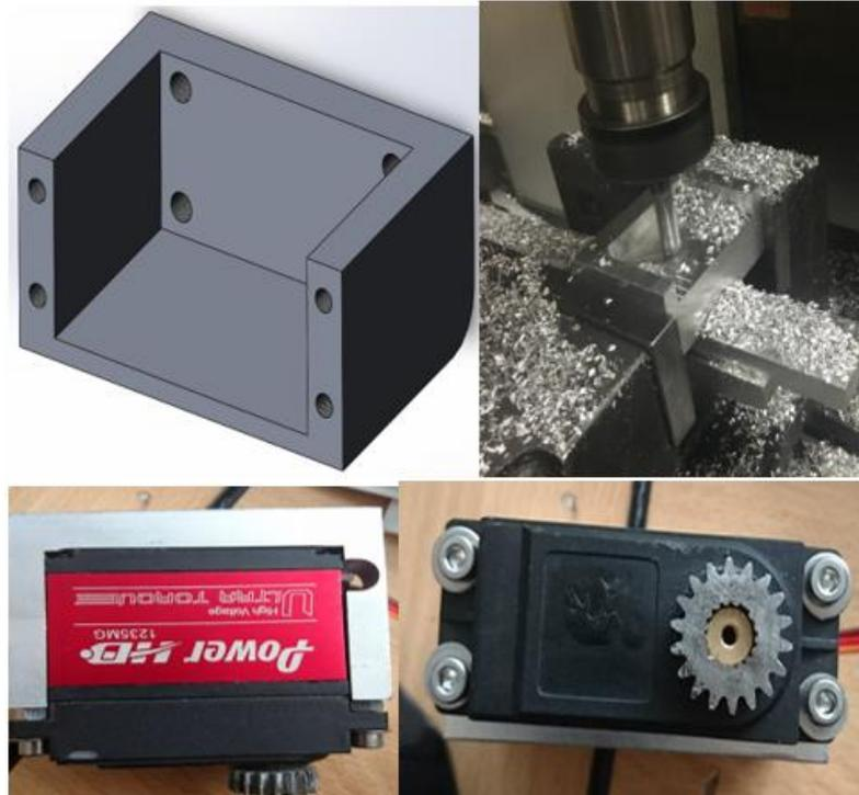
**Figura 82 Mecanizado del soporte del servomotor**
