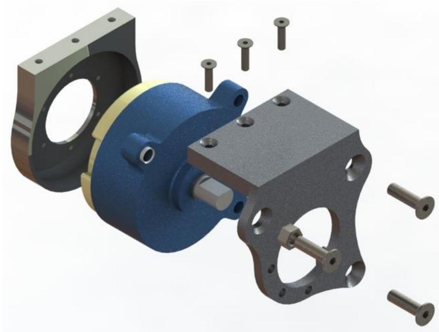
**Figura 57 Ensamble del soporte del limitador**
