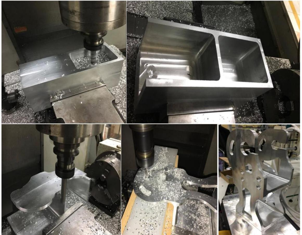
**Figura 85 Proceso de mecanizado del frame**
