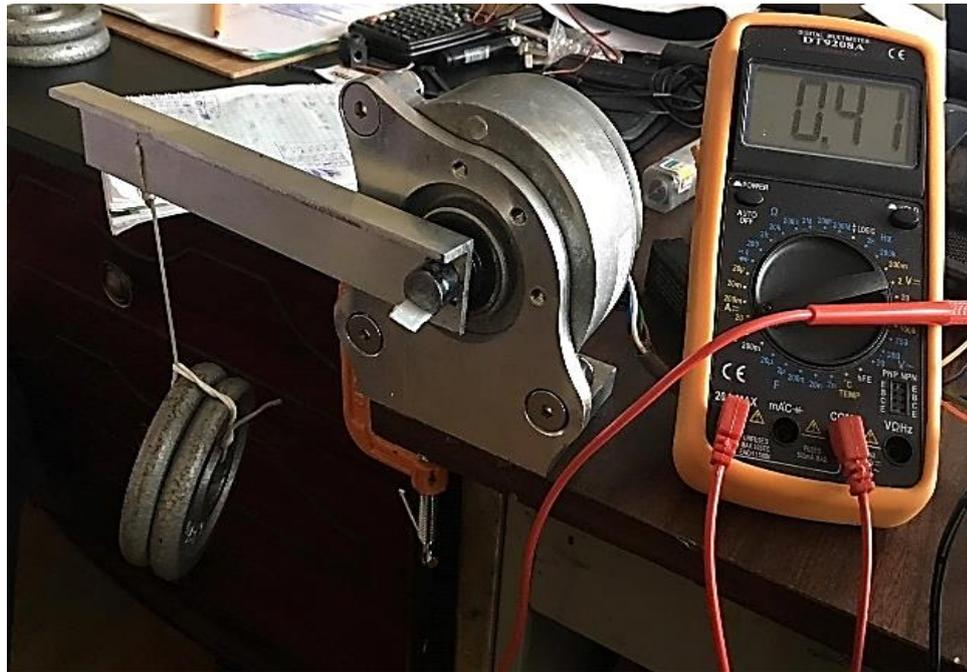
**Figura 101 Prueba del limitador con 1 [Kg]**
