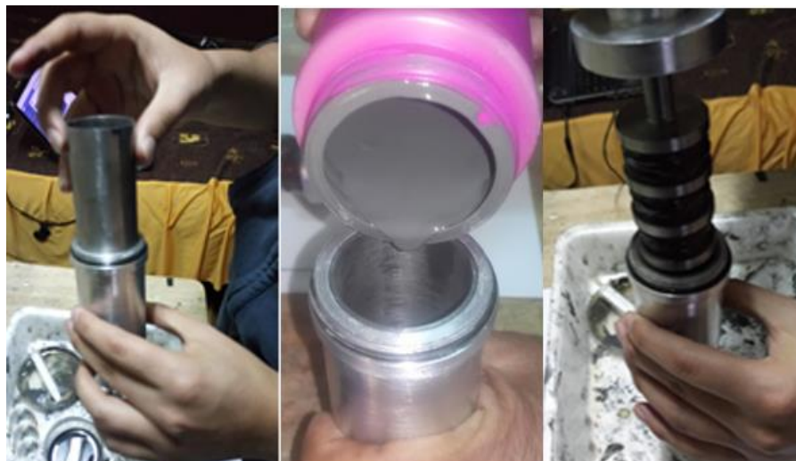
Figura 4.16 Ensamblaje del sistema de amortiguación
