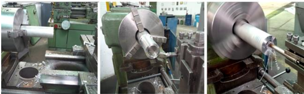
Figura 4.1 Cilindrado externo e interno de la camisa
