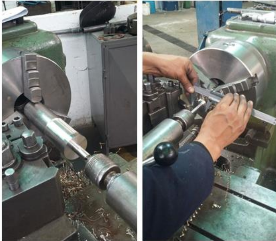
Figura 4.7 Cilindrado vástago y émbolos
