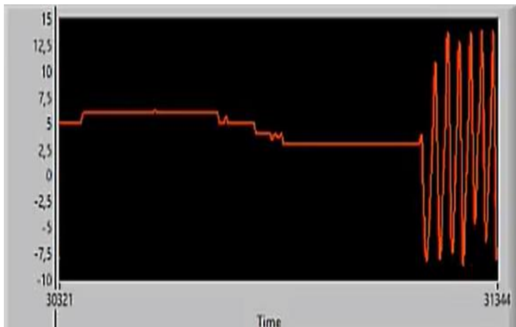
Figura 5.14 Ángulo de lectura del acelerómetro MPU-6050
