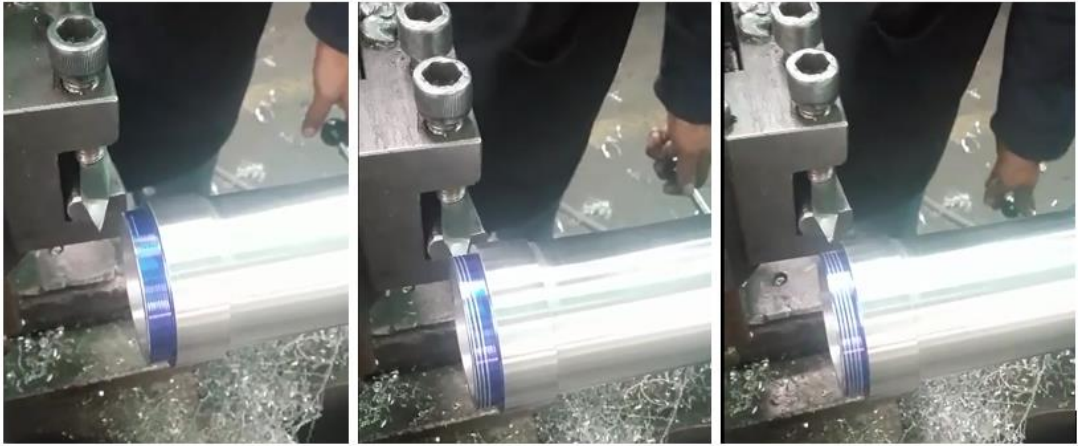
Figura 4.3 Roscado con paso de un milímetro
