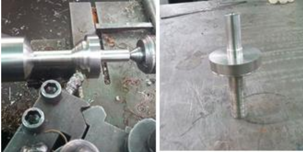
Figura 4.5 Ranurado y corte tapa
