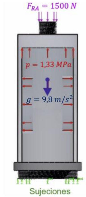
Figura 3.18 Distribución de cargas y sujeciones (Camisa)
