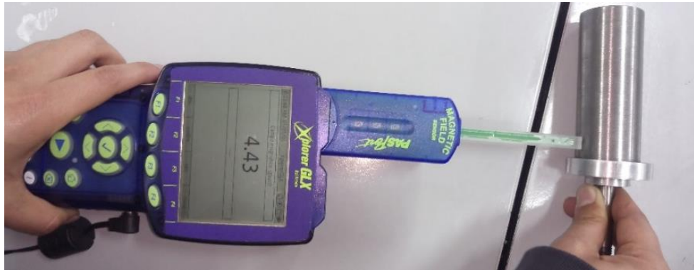
Figura 5.4 Medición campo magnético ante bocín
