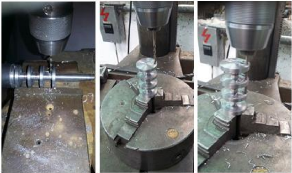
Figura 4.10 Taladrados externos vástago y émbolos
