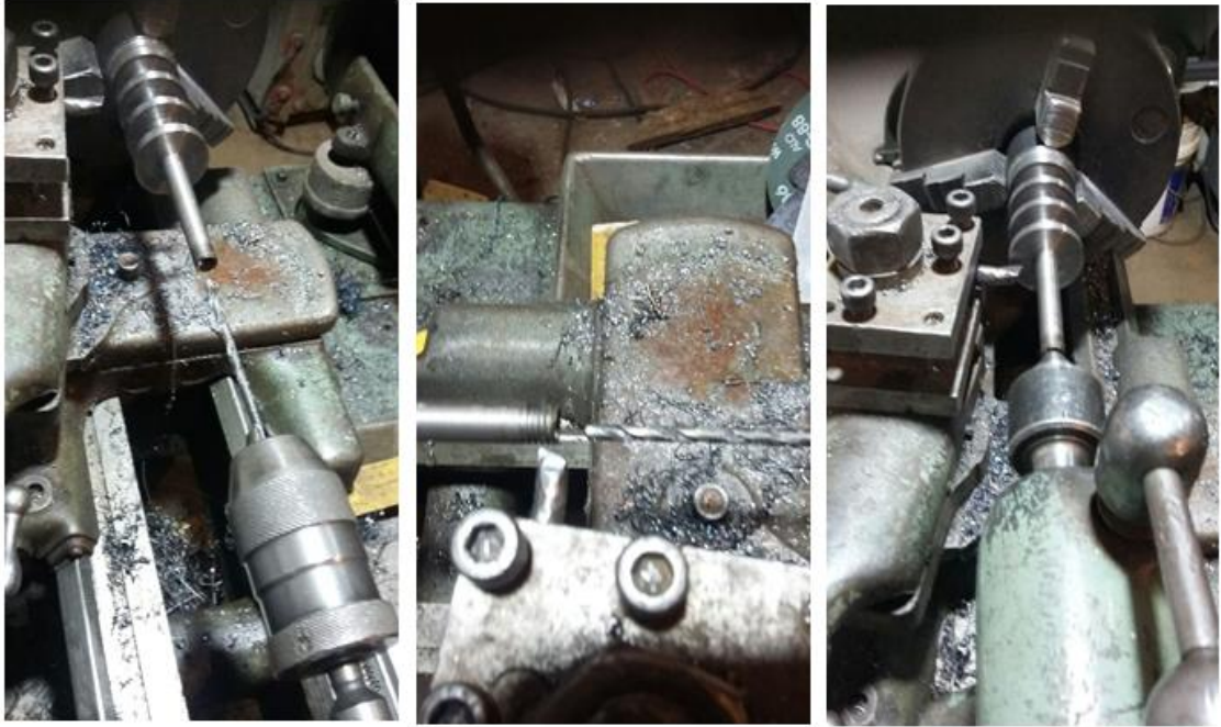
Figura 4.9 Taladrado interno del vástago
