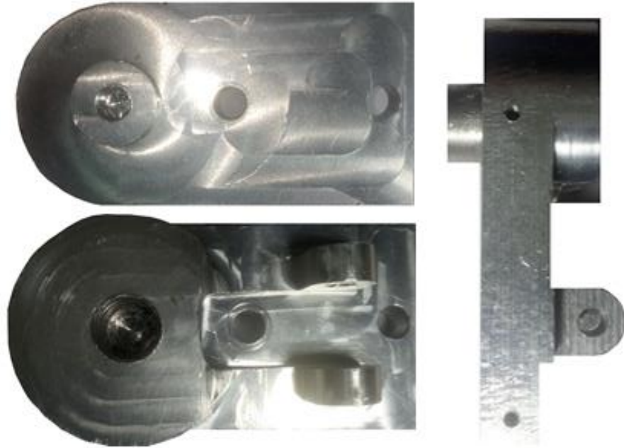
Figura 4.19 Mecanización CNC acople superior
