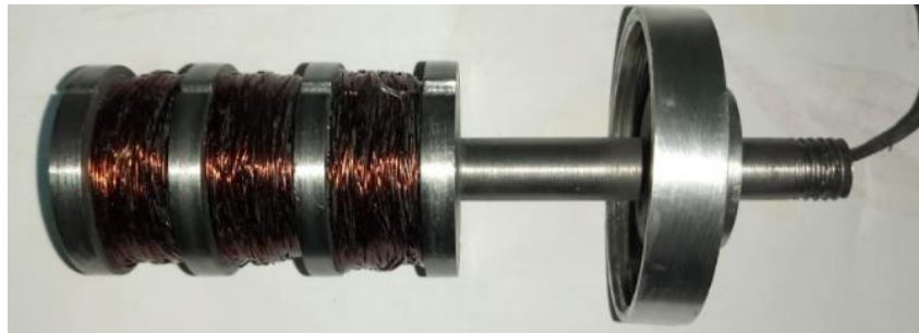
Figura 4.15 Sistema de inducción magnética (Pistón principal)
