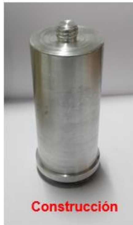
Figura 4.3 Roscado con paso de un milímetro
