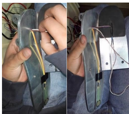
Figura 4.27 Ubicación del cableado de los sensores y ensamblaje
