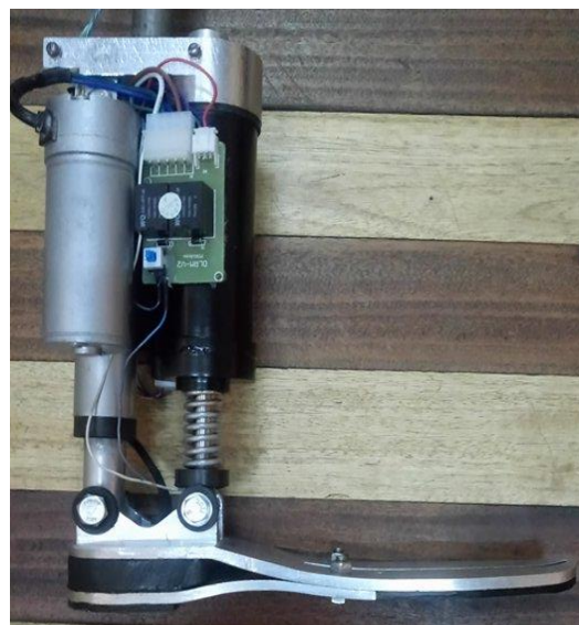
Figura 4.29 Ubicación del controlador del cilindro eléctrico
