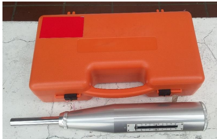
Figura 20: Esclerómetro o martillo Schmidt
