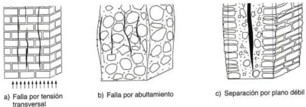
Figura 19: Modo de falla de mampostería ante carga vertical
