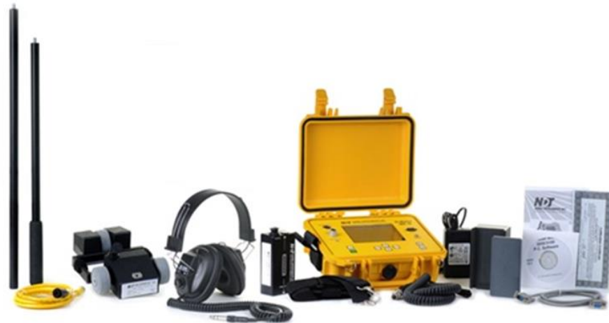
Figura 24: Pachómetro con sus accesorios
