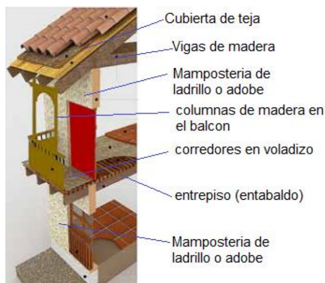
Figura 6: Materiales y sistemas constructivos coloniales
