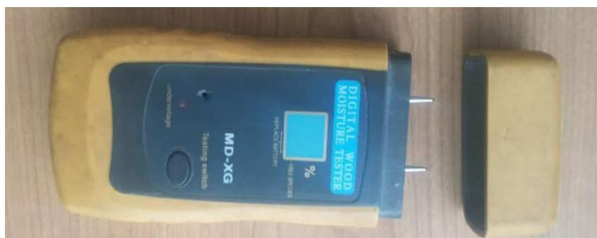
Figura 32: Higrómetro para medición de humedad en la madera
