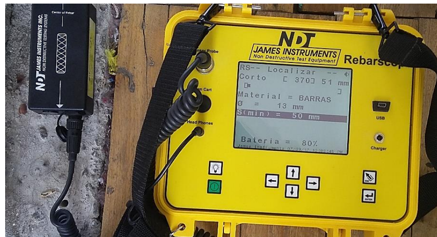
Figura 77: Recubrimiento en una de las vigas perimetrales
