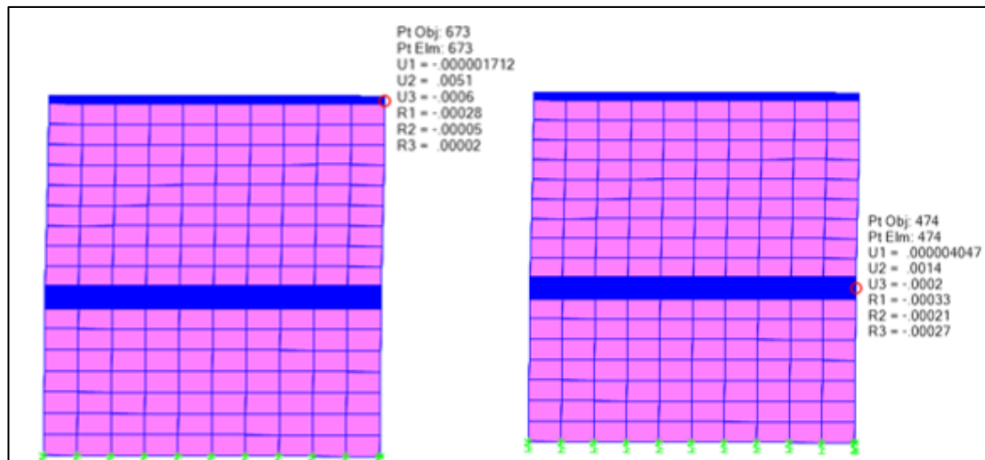
Figura 195: Desplazamientos, muro I, Reforzado
