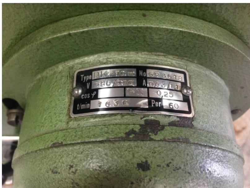
**Figura 20. Placa del motor trifásico**
