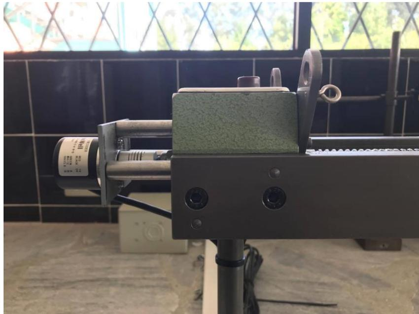
**Figura 87. Estructura de acople del sensor**
