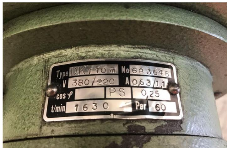
**Figura 50. Placa del motor trifásico**
