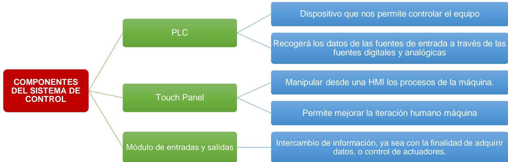
Figura 3. Componentes del Sistema de Control
