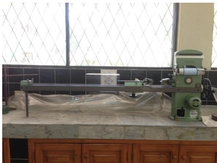
Figura 19. Máquina de ensayos de tracción horizontal
