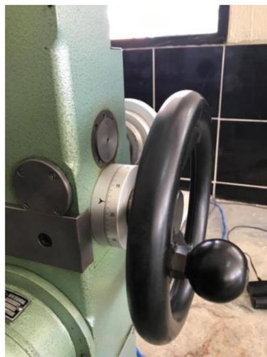
**Figura 96. Medidor de desplazamiento máquina antigua**
