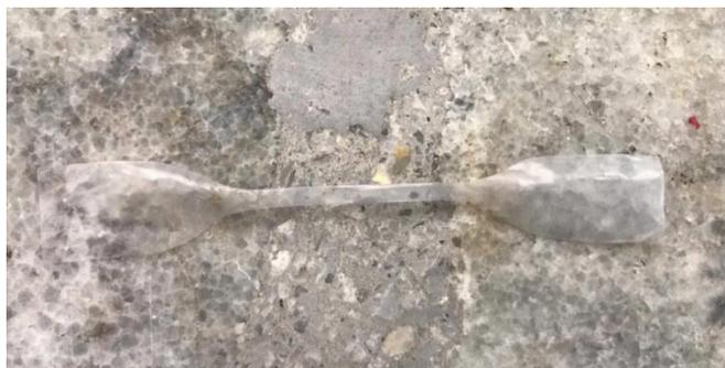
Figura 98. Probeta plástico dúctil
