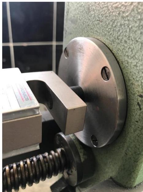
**Figura 89. Acople celda de carga**
