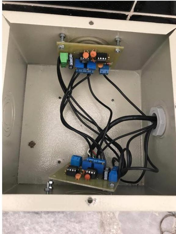
**Figura 94. Caja del circuito de acondicionamiento**
