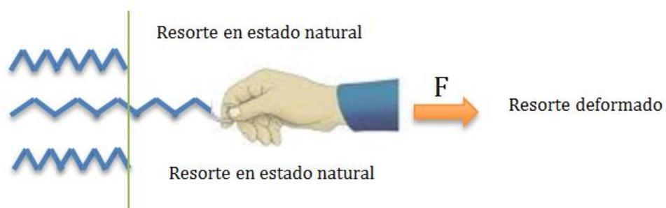
**Figura 10. Deformación elástica**
