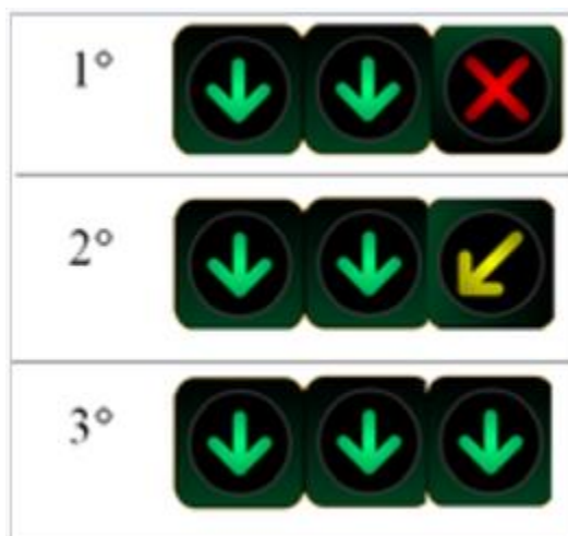
Figura 53 Semáforos para la regulación del uso de carriles
