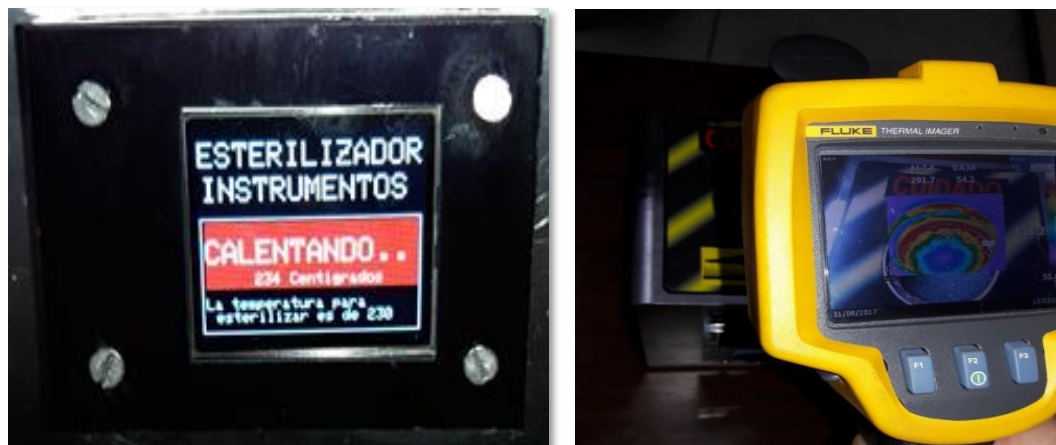
Figura 100. Comparación entre medición del sensor y la cámara térmica
