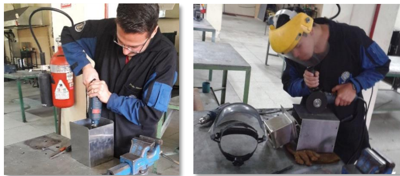
Figura 69. Procesos efectuados de Taladrado y Corte
