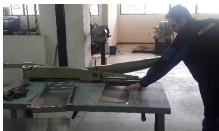
Figura 65. Corte de chapa metálica
