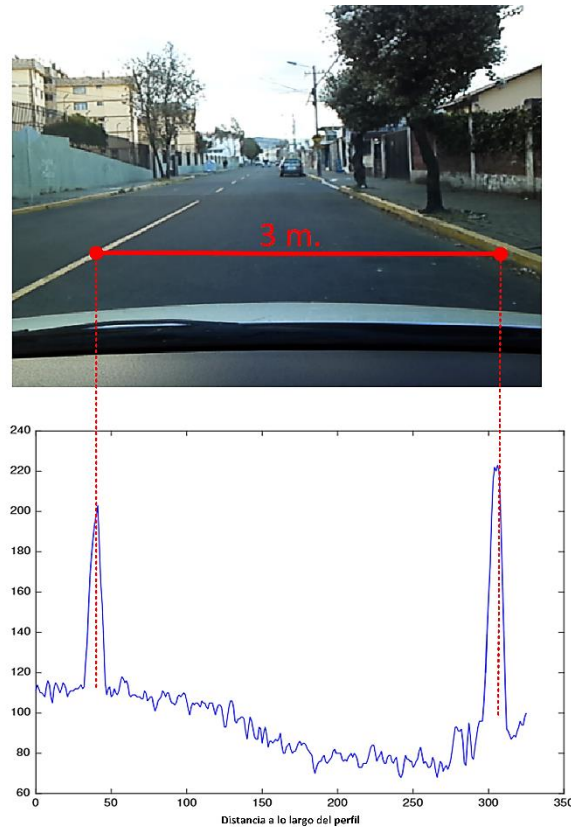
Figura 6. Extracción del perfil de gradiente de intensidad sobre una línea horizontal
