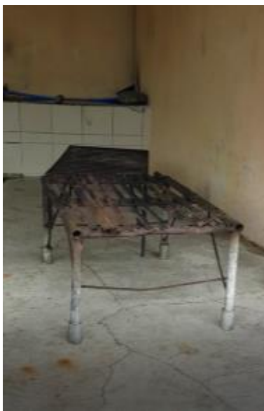
Figura 35 Camal Los Bancos no cumple con accesorios de acero inoxidable
