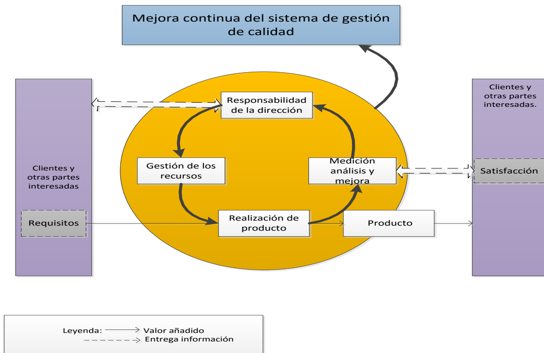
Figura 1: Modelo de un sistema de gestión de la calidad basado en procesos
