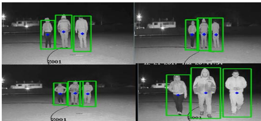
Figura 55 Detección de personas usando LBP (nocturna).
