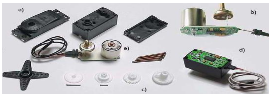
Figura 6 a) Carcaza b) Sensor c) engranajes d) controlador e) motor DC.
