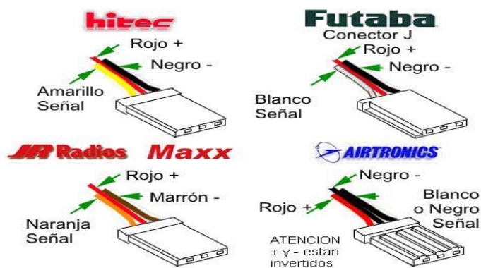
Figura 7 Pines de un servomotor.
