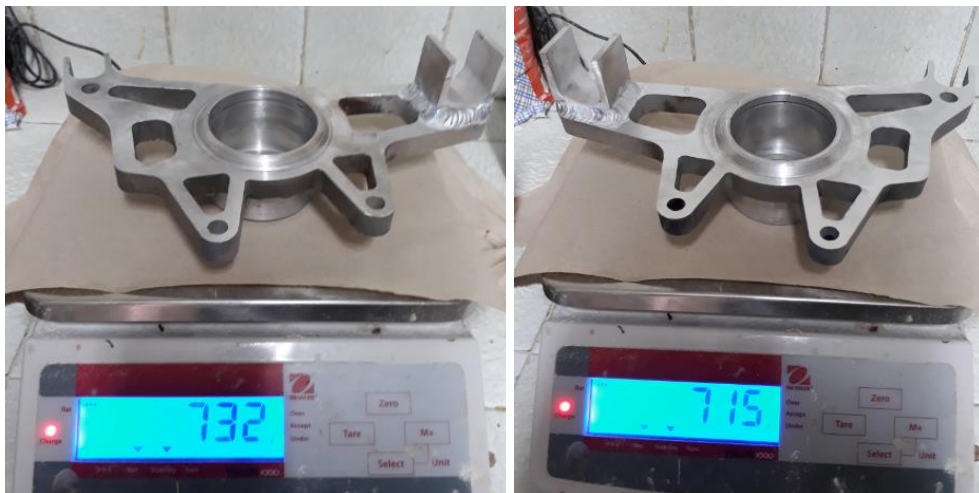
Figura 67. Medición de peso de las manguetas en Aluminio AW7021.
