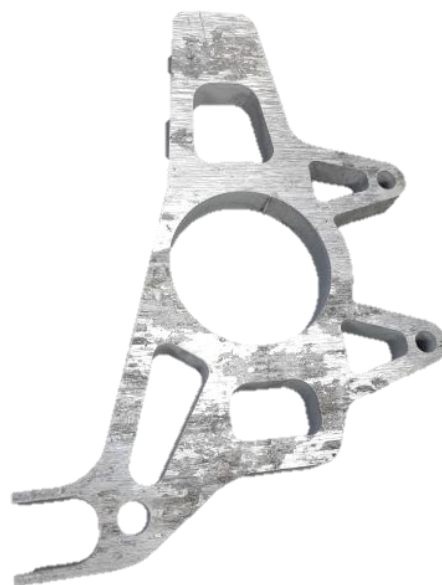
Figura 55. Plancha base para la mangueta después del corte de agua
