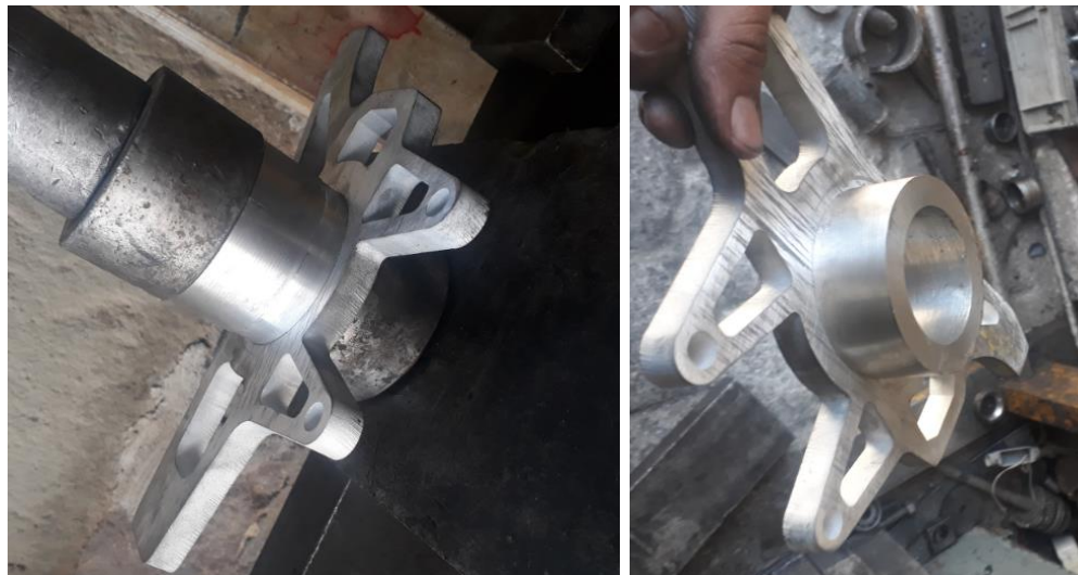
Figura 57. Mangueta después de ser prensada
