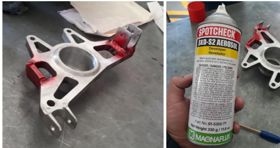
Figura 69. Ensayo por tintas penetrantes
