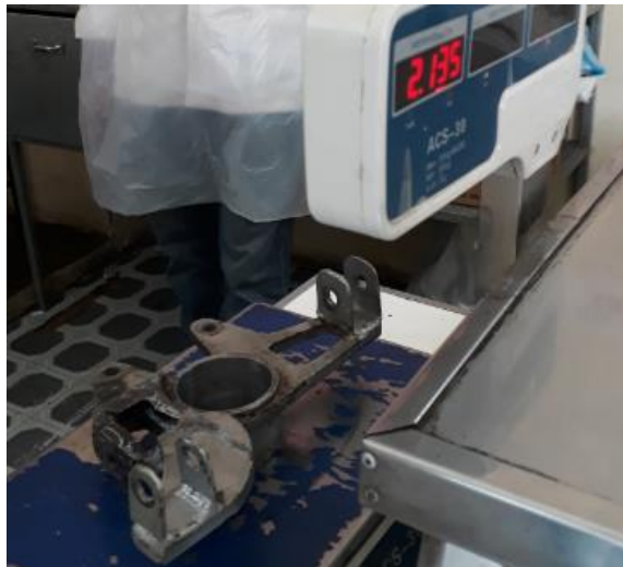
Figura 65. Medición de peso mangueta Acero A36
