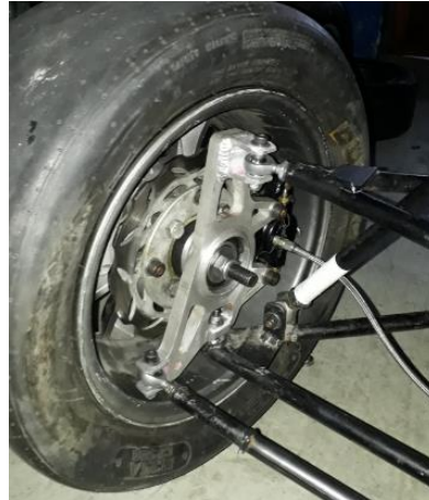
Figura 73. Conjunto mangueta ensamblado
