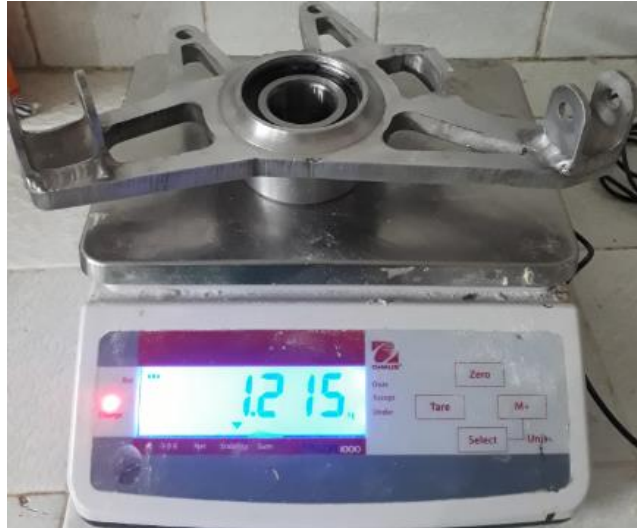
Figura 71. Medición de peso conjunto mangueta - rodamiento
