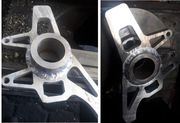
Figura 60. Conjunto de la mangueta después de soldada
