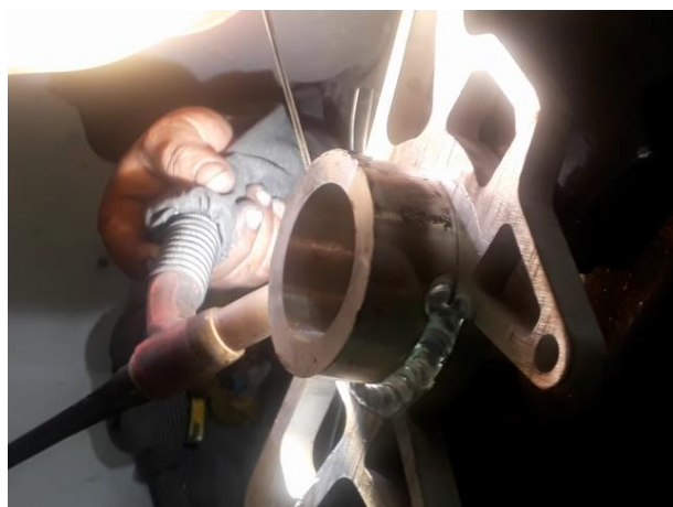
Figura 59. Proceso de soldadura TIG de la mangueta
