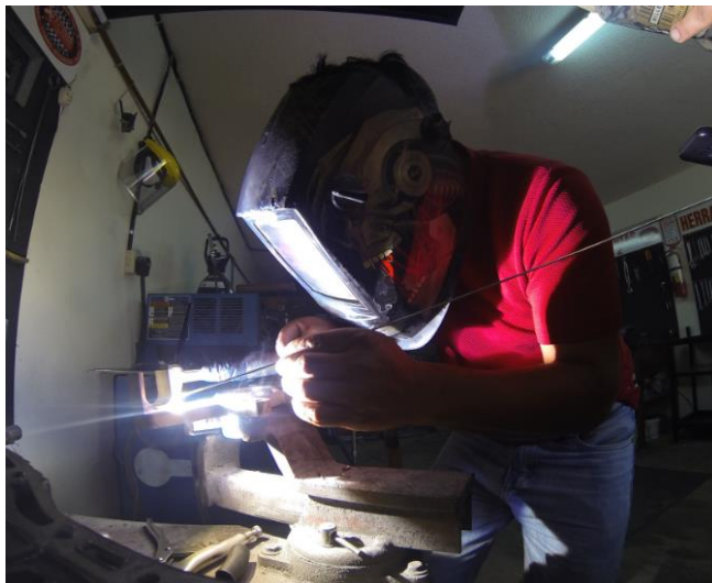
Figura 63. Soldadura de anclaje mesa superior
