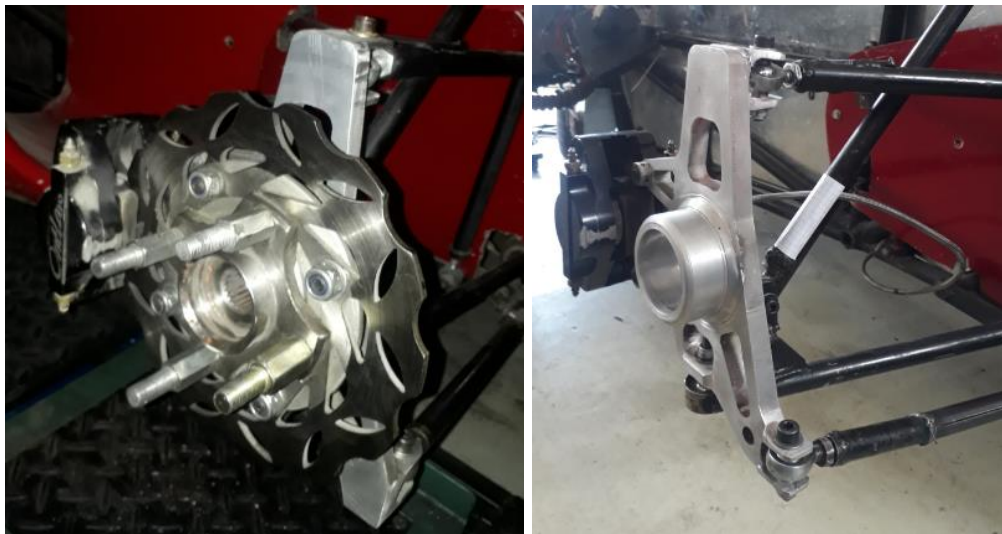
Figura 72. Ensamblaje del conjunto mangueta
