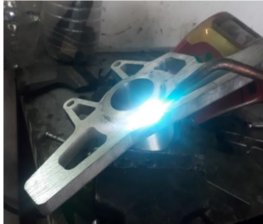
Figura 58. Calentamiento de la mangueta para soldarla
